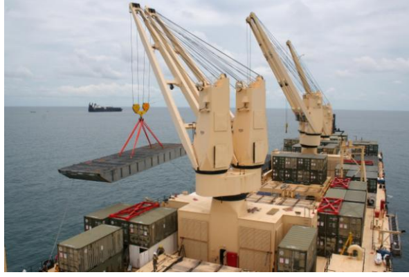
Şekil 2.15 : Gemi Vinçleri ile Konteynırların Elleçlenmesi[11].
