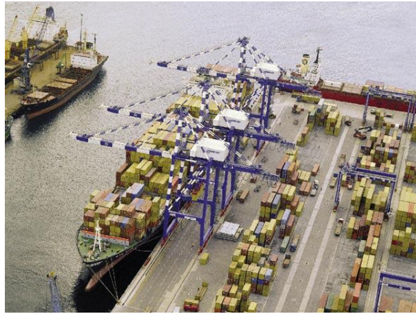
Şekil 2.16 : Rıhtım Vinçleriyle Konteynırların Elleçlenmesi[12].
