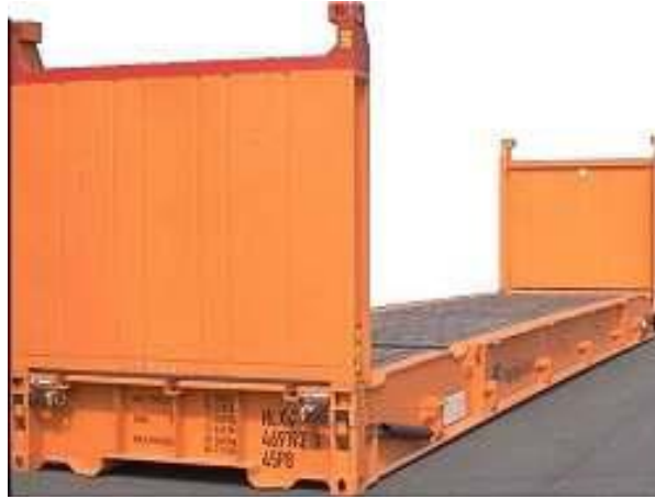
Şekil 2.4 : Flat Rack Konteynır[6].
