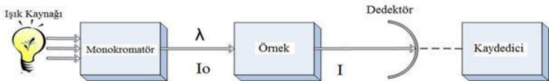
Şekil 4.4: Tek ışın demetli spektrofotometre (Url 7)
