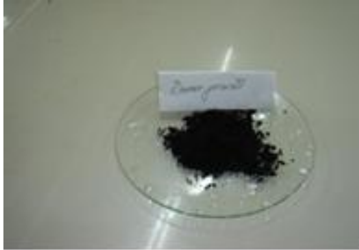
Şekil 3.1: Bu çalışmada adsorban madde olarak kullanılan GDH materyali
