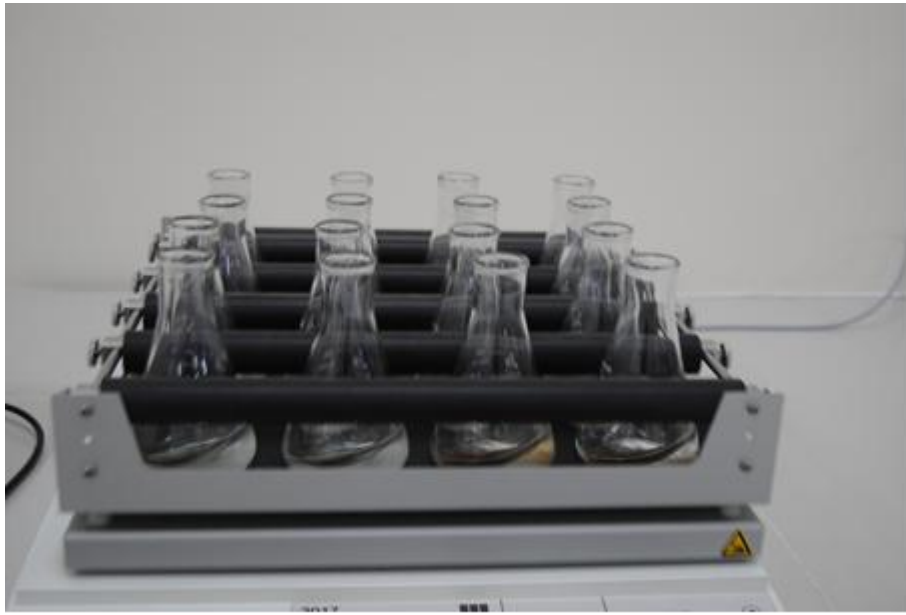
Şekil 3.2: Adsorpsiyon denge zamanı belirleme çalışmaları
