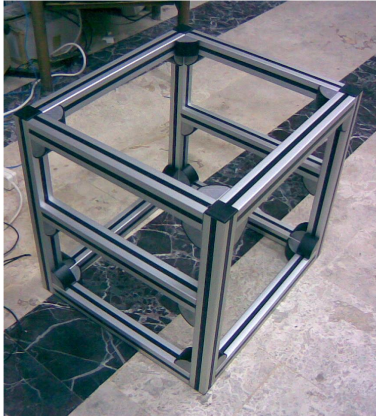
Şekil 4.6 : Profil kafes sistemi
