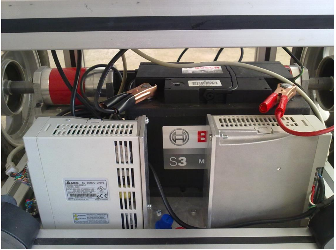
Şekil 4.10 : Aküden 12V elde edilmesi
