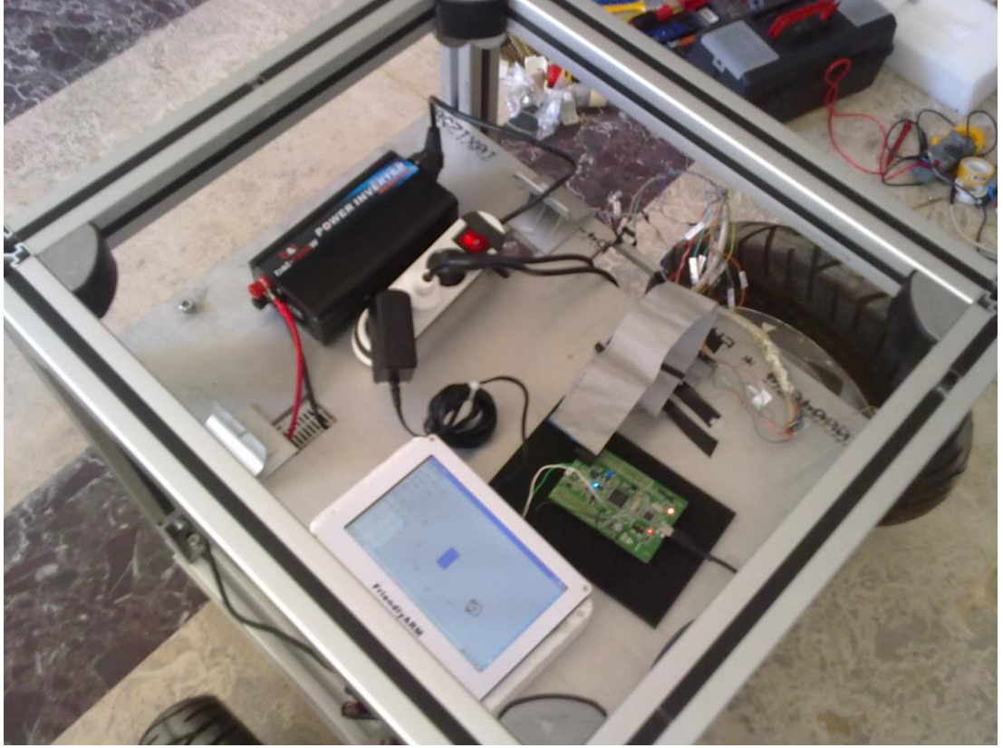
Şekil 4.13 : STM32F4 ile servo sürücü haberleşmesi
