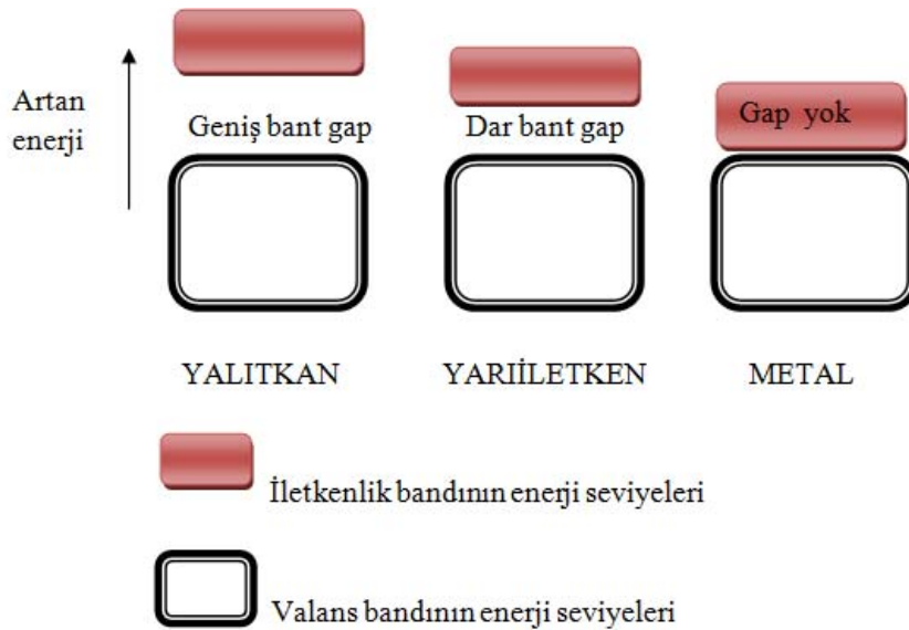
Şekil 2.2 : Bant boşluğunun iletkenliğe etkisi
