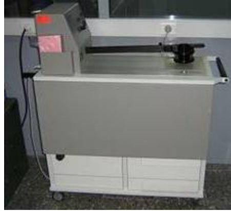
Şekil 3.2: Hava geçirgenliği test cihazı.
