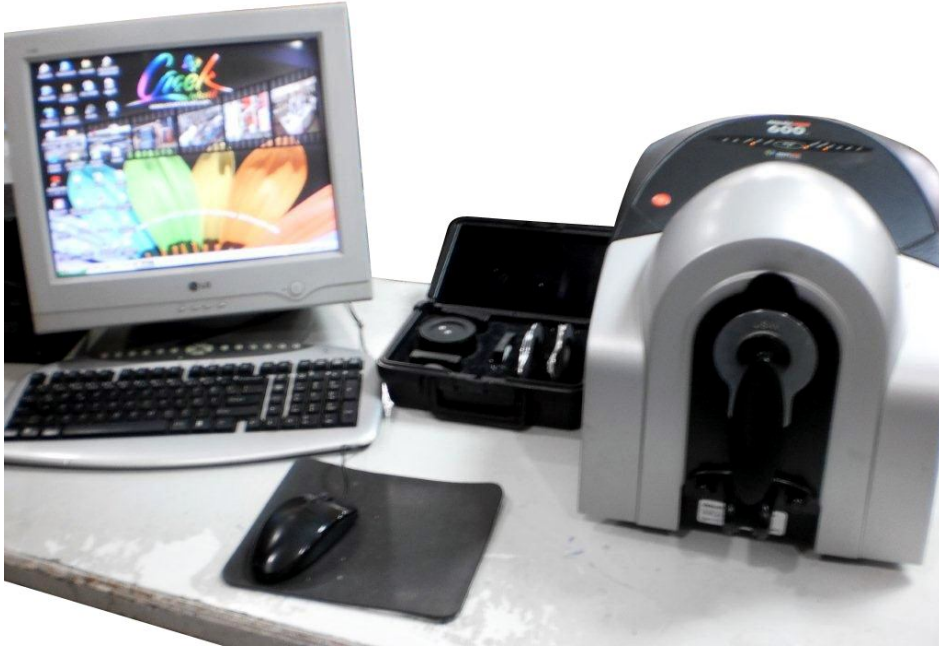
Şekil 4.6 : Datacolor 600 renk ölçüm cihazı
