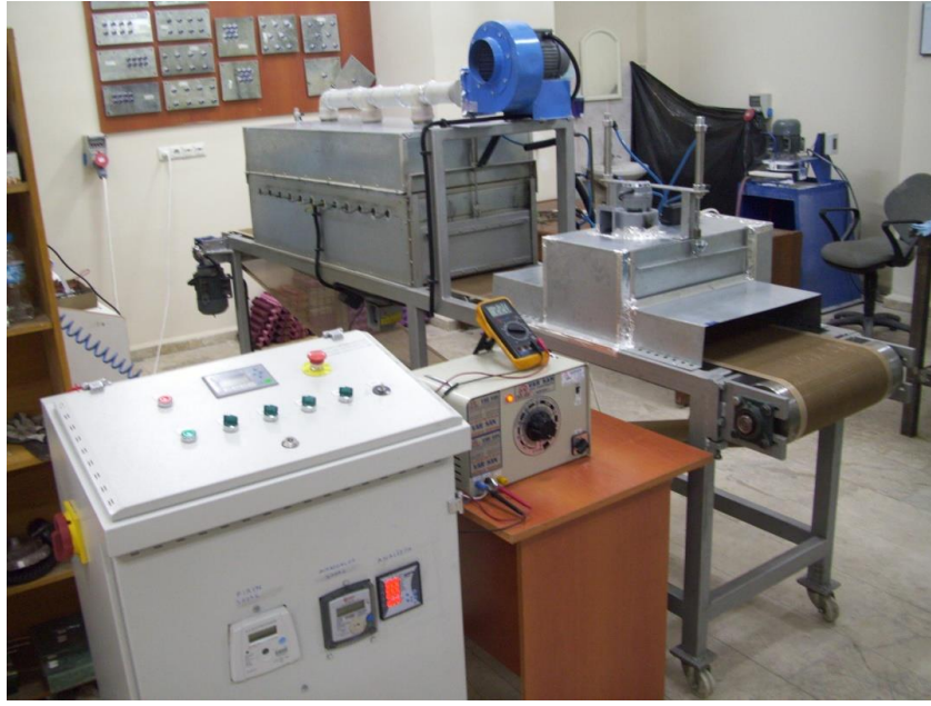
Şekil 3.1: MW-fan destekli konveksiyon ısıtma sistemi.
