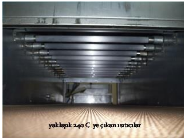
Şekil 3.5: Rezistanslı fırının iç kısmı.
