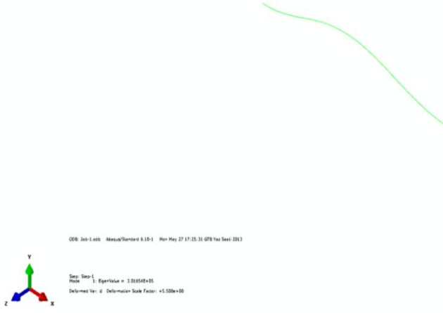
Şekil 5.4: ABAQUS programında Kiriş 6'ya ait C-C sınır şartı için 1. Mod şekli
