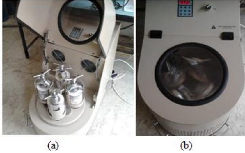
Şekil 3.6: Planet Tip Karıştırıcı (a) durağan durumda (b) çalışır durumda
