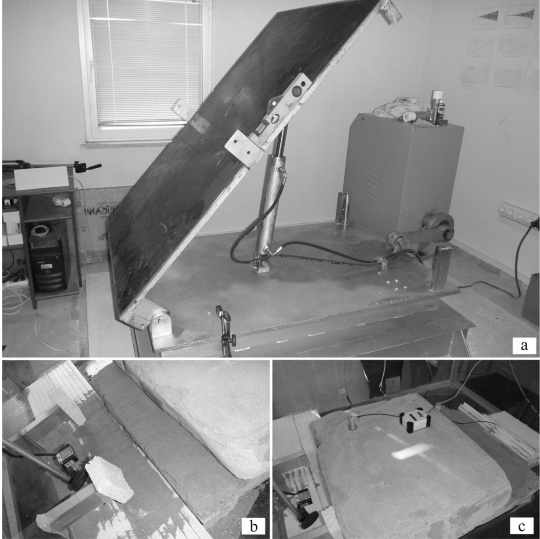
Şekil 7.1 : Eğimlendirme deney düzeneği (a: 45°'ye kadar eğimlendirilebilen masa, b: kayma öncesi fiziksel modelin görünümü, c: deney sonu görünüm).
