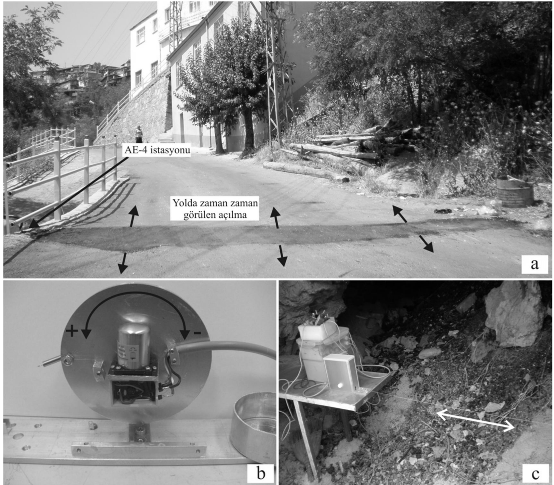
Şekil 5.16 : AE-4 istasyonu mesafe ölçüm sistemi (telin gerilmesiyle dönen diske sabitlenmiş eğim algılayıcı (a), istasyonun görünümü (b)).
