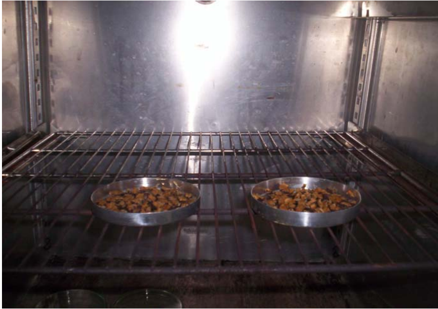
Şekil 9.1 Etüvde elmaların nem ve kuru madde tayini için kurutulması.
