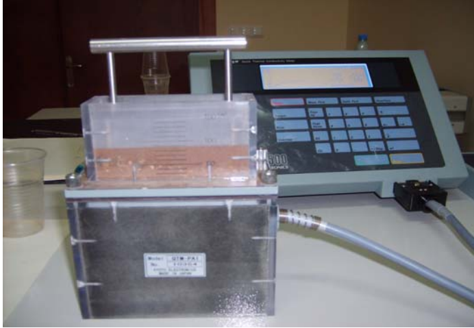
Şekil 4.12 QTM500 cihazı ile toprağın ısı iletim katsayısının ölçülmesi.
