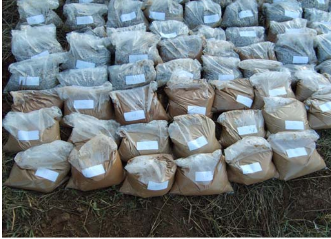
Şekil 4.8 Sondaj sırasında sondaj çukurundan alınan toprak numuneleri.
