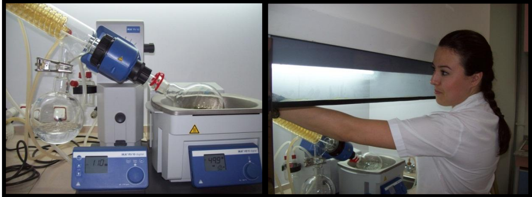
Şekil 2.4 : Rotary evaporatörde çözücü kısmının uzaklaştırma işlemi
