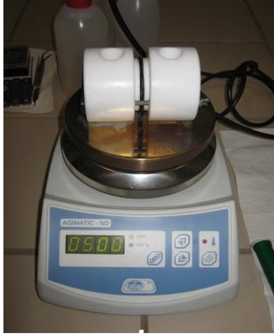
Şekil 4.2.b: Destekli sıvı membran transport deneyleri için kullanılan deney düzeneği
