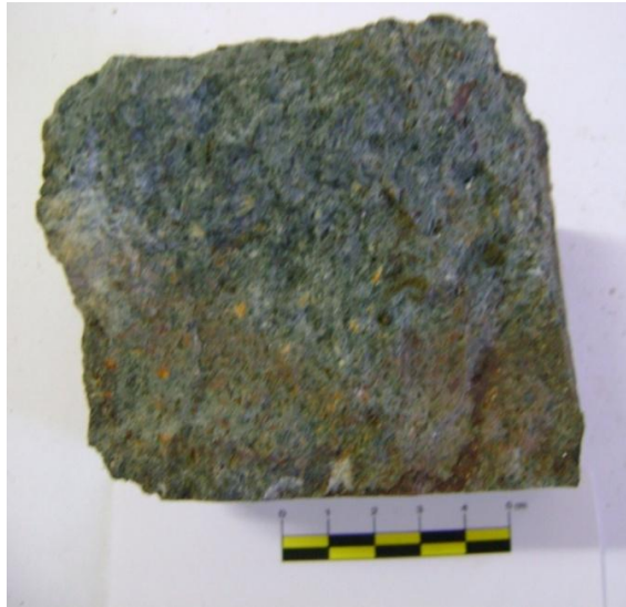
Şekil 4.7 Hodul birimi içerisinde bulunan metabazalt el örneğinin (EVP-18) görünümü.
