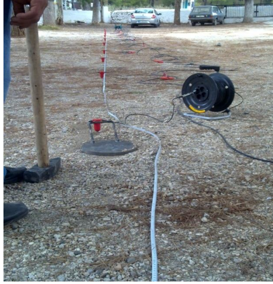
Şekil 3.3: Ula-Karabörtlen ilköğretim okulu doğal zemin MASW ölçümlerinden bir görüntü
