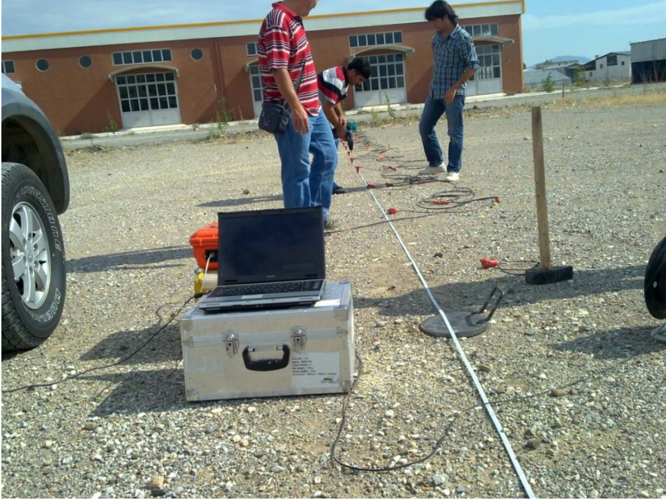
Şekil 4.8: MASW ölçümlerinden bir görünüm (Ortaca Meslek Yüksekokulu yurt binası doğal zemin)
