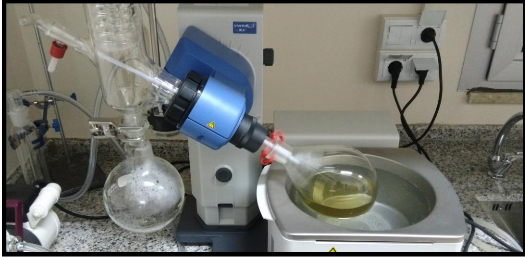
Şekil 2.1 Evaporatör (rotary) ile çözgeni uzaklaştırma işlemi.
