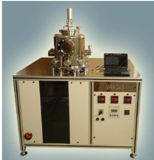
Şekil 2.12 : Termal buharlaştırma sistemi (Gölcür 2012).
