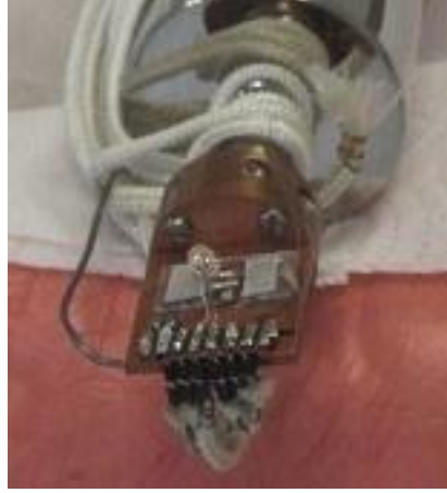
Şekil 3.5 : Fotoiletkenlik ölçümü için kriyostat içerisine yerleştirilmiş numune ve LED'in fotoğrafı .
