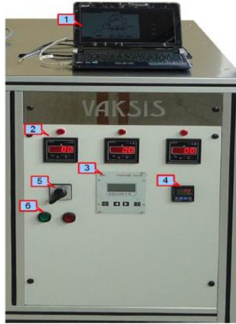
Şekil 2.15 : Termal buharlaştırma sisteminin elektronik kabin ünitesi 1) Kontrol bilgisayarı, 2) Ampermetreler ve termal buharlaştırma güç kaynakları göstergeleri, 3) Turbo pompa kontrolör, 4) Sıcaklık PID kontrolör, 5) Ana şalter, 6) Aç/Kapa Anahtarları.
