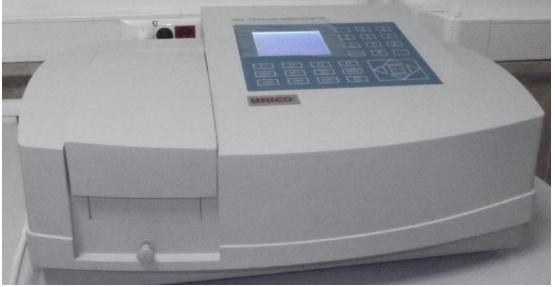
Şekil 3.11 : Soğurma ölçümlerinde kullanılan UV-Vis spektrometresi.
