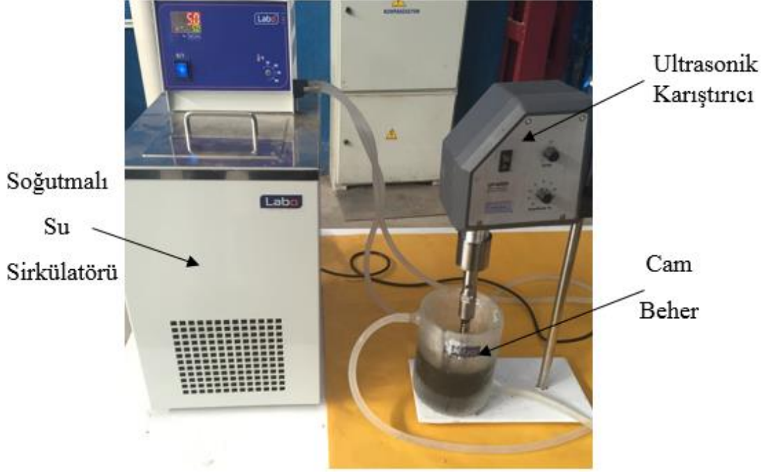
Şekil 4.2: Nano karbon-epoksi reçine karışımın sonikasyon işlemi.
