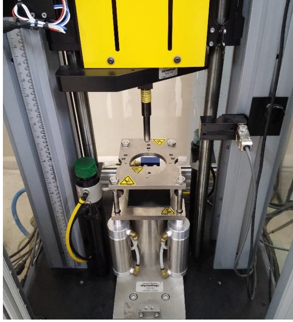
Şekil 4.9: Kompozit numuneye darbe testinin uygulanması.
