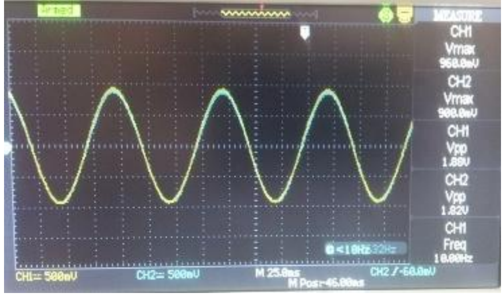
Şekil 8-17: MFB Süzgeç 10 Hz genlik cevabı
