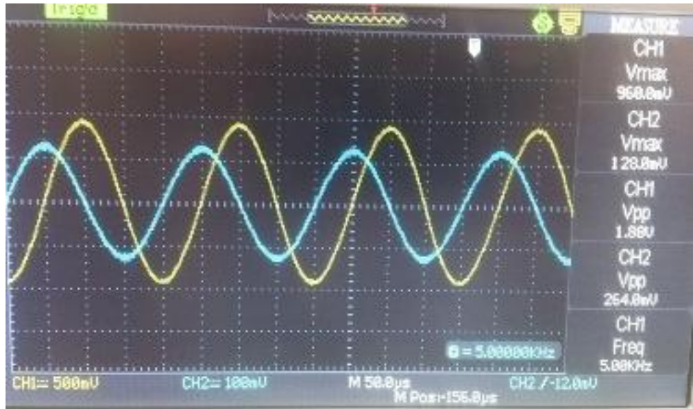
Şekil 8-20: MFB Süzgeç 5 kHz genlik cevabı
