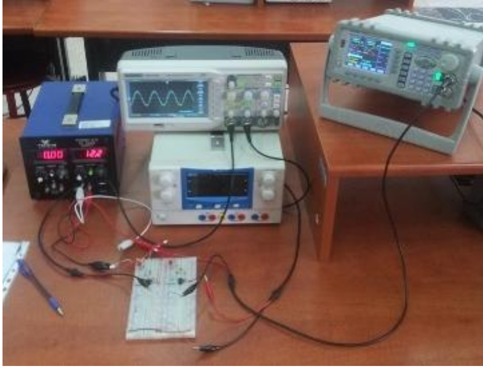
Şekil 8-16: Proje devresi prototip
