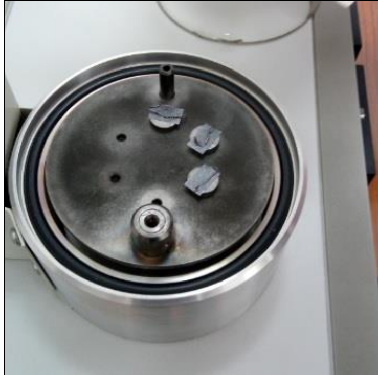
Şekil 2.16: Parazit örneklerinin altın-paladyum ile kaplandıktan sonraki hali
