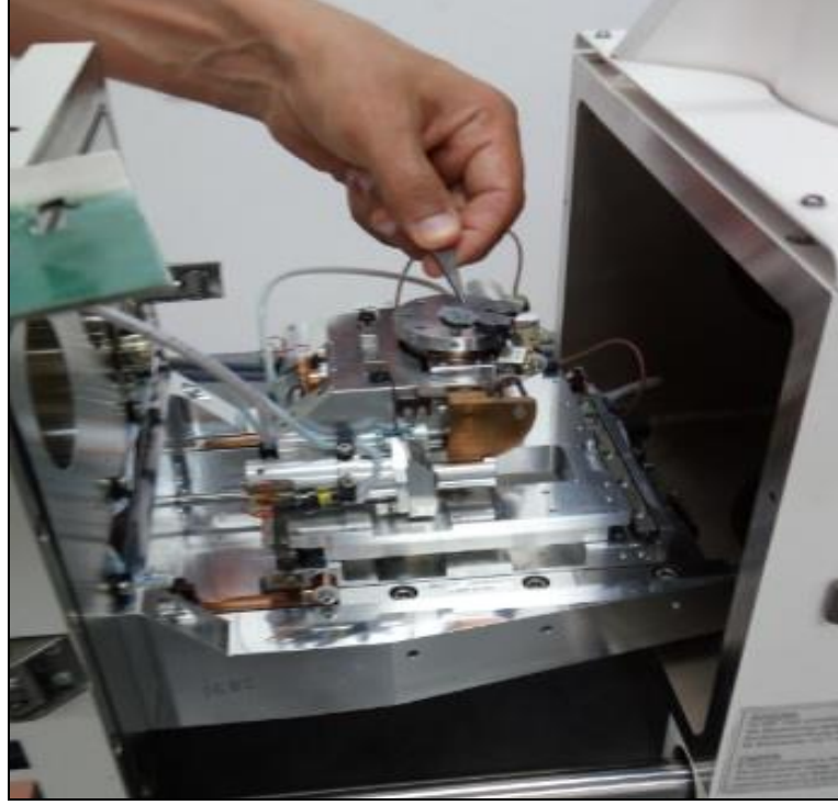
Şekil 2.17: Parazit örneklerinin elektron mikroskobuna yerleştirilmesi
