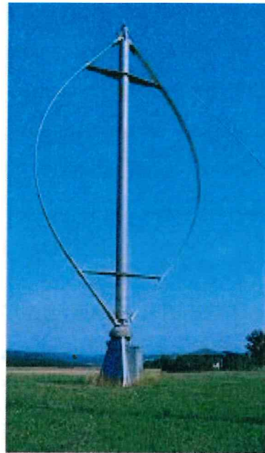
Şekil 2.3: Darrieus Tipi Dikey Eksenli Rüzgâr Türbinleri
