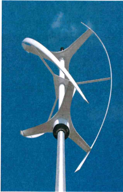
Şekil 2.3: Darrieus Tipi Dikey Eksenli Rüzgâr Türbinleri
