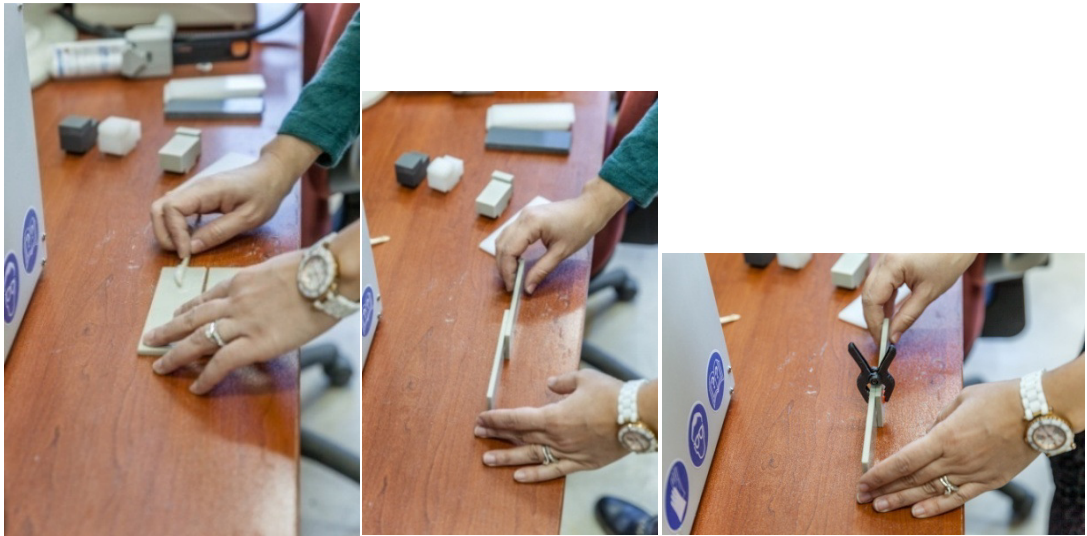
Şekil 4.5: Çekme deney numunelerinin yapıştırılması.
