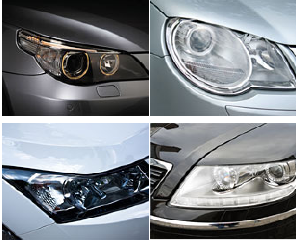
Şekil 2.8: Plazma teknolojisi ile yapıştırılan led far uygulamaları (Plasmatreat 2016).
