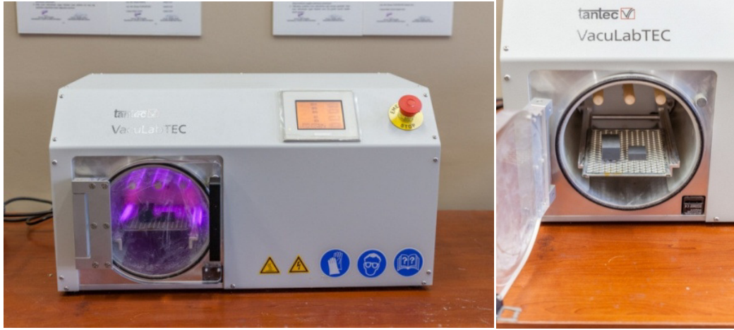
Şekil 4.4: Plazma yüzey işlemi uygulaması yapılan tantec vaculab sistemi.
