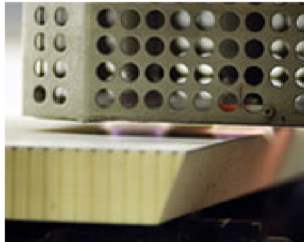
Şekil 2.10: Sandviç panel üzerinde plazma uygulaması.
