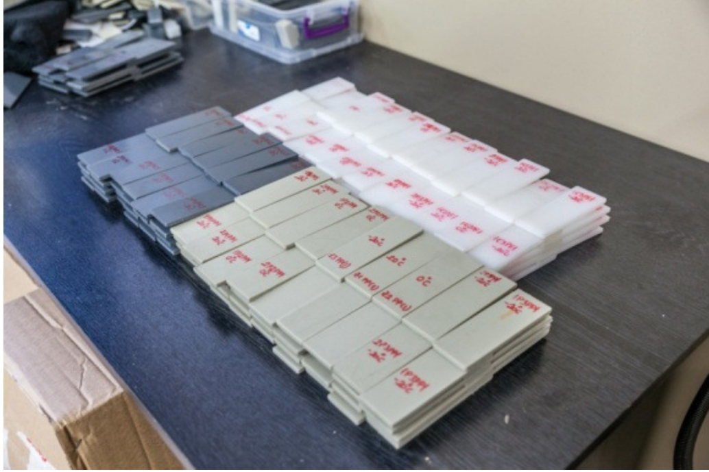
Şekil 4.6: Yapıştırılmış çekme deney numuneleri.
