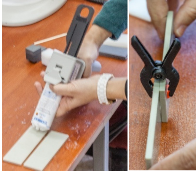
Şekil 4.7: Numunelerin yapıştırılma aşamaları.
