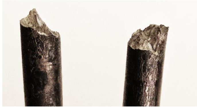
Şekil 6.53: İşlemsiz Ti6Al4V alaşımının çekme deneyi sonrası görüntüsü.
