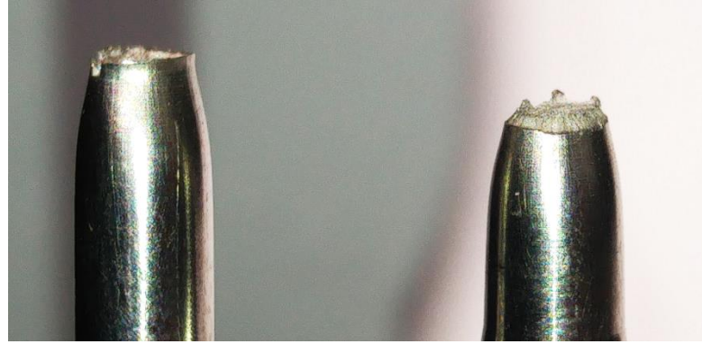
Şekil 6.53: İşlemsiz Ti6Al4V alaşımının çekme deneyi sonrası görüntüsü.
