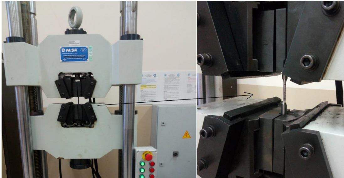
Şekil 5.20: Çekme testlerinde kullanılan çekme deney cihazının görüntüsü.
