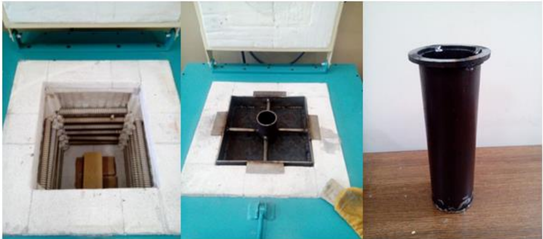
Şekil 5.17: Sıvı borlama deneylerinde kullanılan fırın, aparat ve pota.
