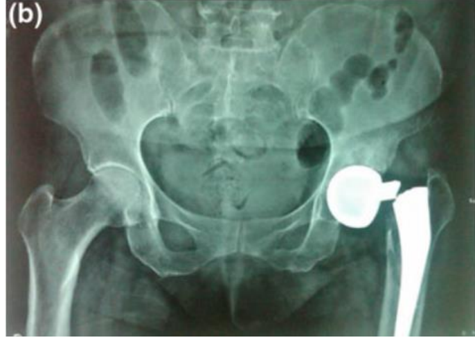
Şekil 3.8: Total kalça protezinde femoral stemin kırılması.
