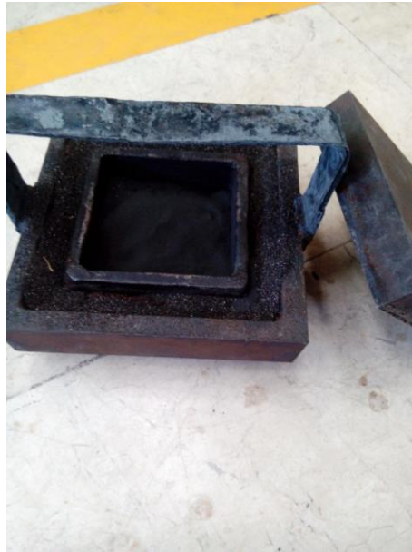
Şekil 5.15: Ekabor-2 ile borlama işlemi için hazırlanan kutu.
