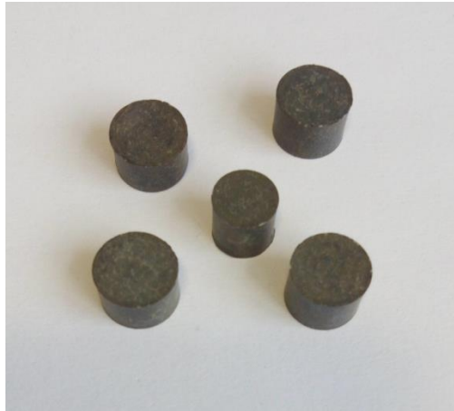
Şekil 5.33: Cilt içi irritasyon testi için hazırlanan 1100 °C'de 20 saat borlanmış deney numuneleri.
