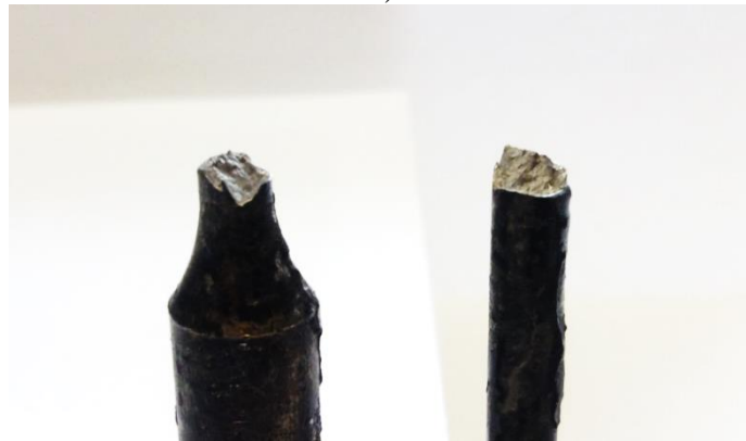
Şekil 6.54: 1100 °C'de 20 Saat a) sıvı ortamda borlanmış b) katı ortamda borlanmış Ti6Al4V numunelerin çekme deneyi sonrası görüntüleri.
