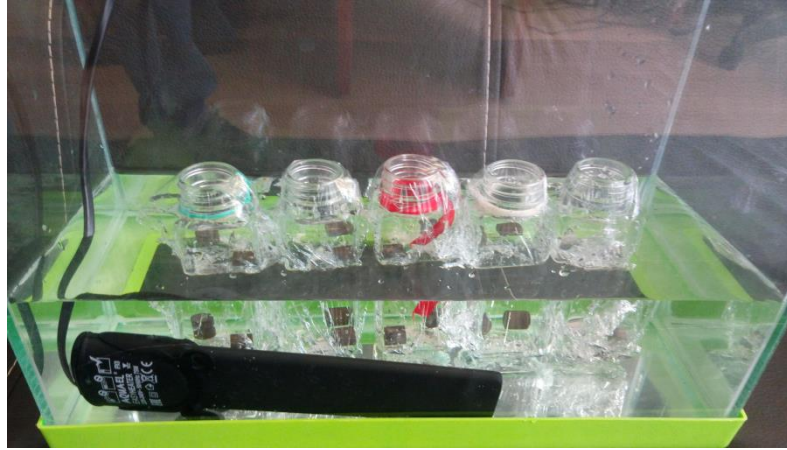
Şekil 5.26: Korozyon sonucu oluşacak ağırlık kaybının tespiti için hazırlanan deney düzeneği.
