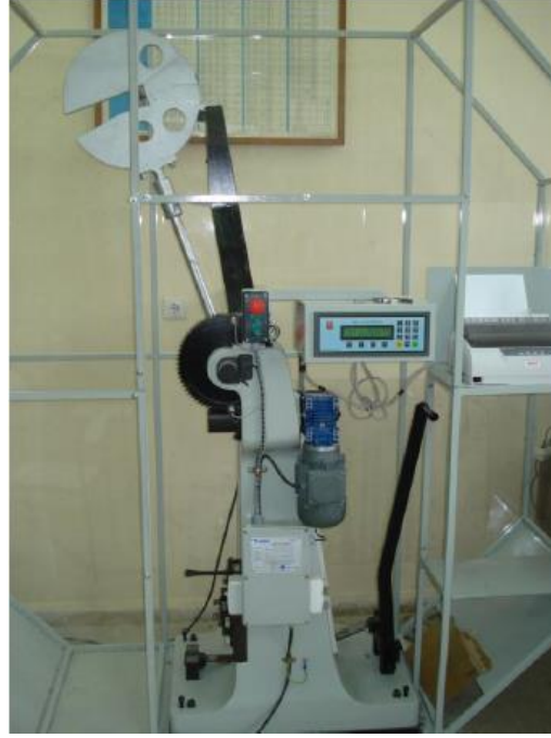
Şekil 5.23: Charpy çentik darbe cihazı.
