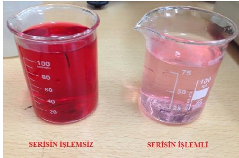
Şekil 5.62: Eriofast Red B ile 95°C'de boyanan serisin ön işlemlili ve serisin ön işlemlisiz yün numunelerinin boyama sonrası atık flotteleri
