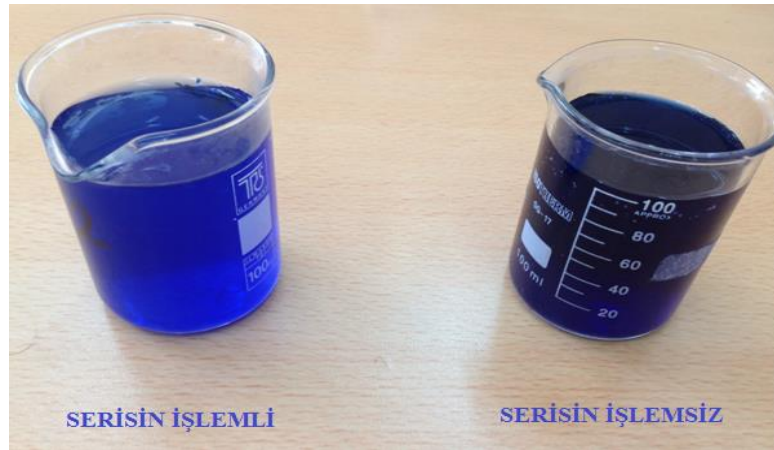
Şekil 5.66: Eriofast Blue 3R ile 95°C'de boyanan Serisin ön işlemlili ve serisin ön işlemsiz yün numunelerinin boyama sonrası atık flotteleri
