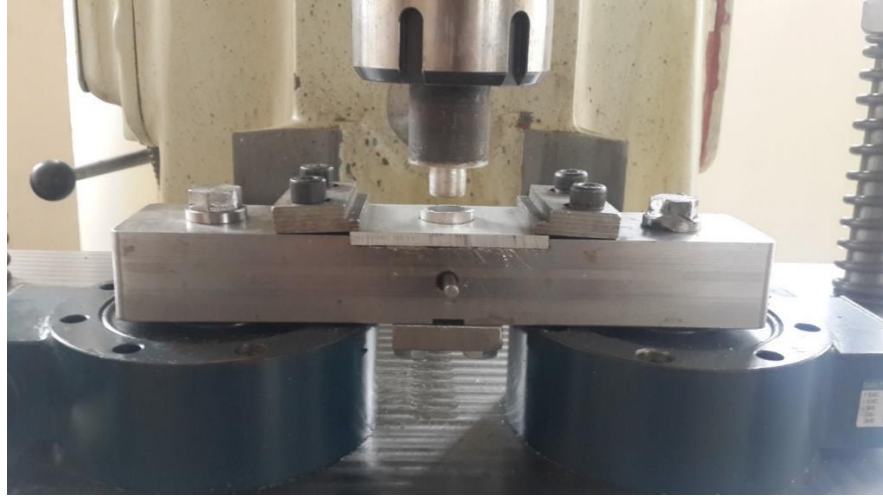
Şekil 4.8: Asıl deneyler esnasında kullanılan tutturma aparatı ve numunelerin bağlanmış şekli
