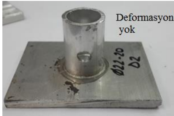
Şekil 4.18: Boru sabitleme deliği açılarak kaynak yapılmış numune
