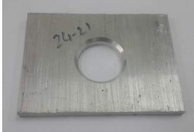
Şekil 4.20: Plaka üzerine kaynak ağzı açılmış numune
