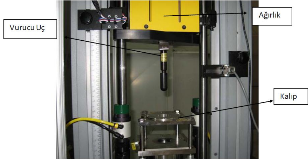
Şekil 3.1 Ağırlık düşürme deney düzeneği
