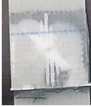
Şekil 3.4 Bindirme numunelerinde fiber kırılması
