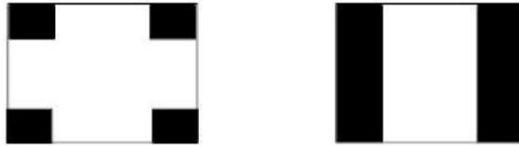
Şekil 3.3 : Van-der Pauw ve şerit kontak geometrisinde kontak alınmış ince filmler.
