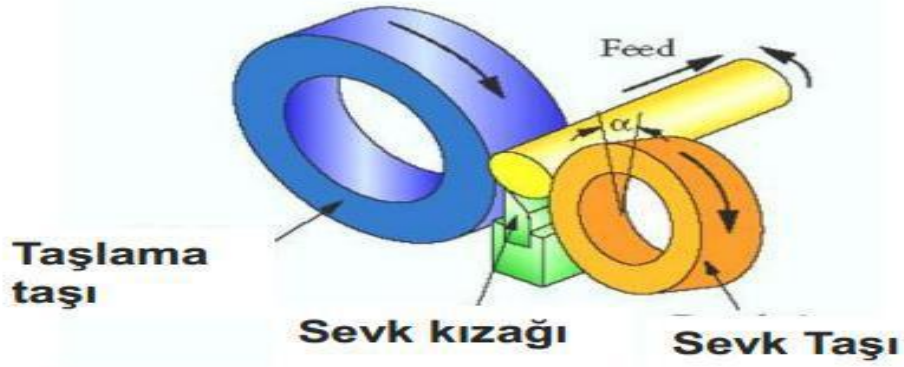
Şekil 4.17: Puntasız taşlama işlemi şematik gösterimi (Akdamar 2014).
