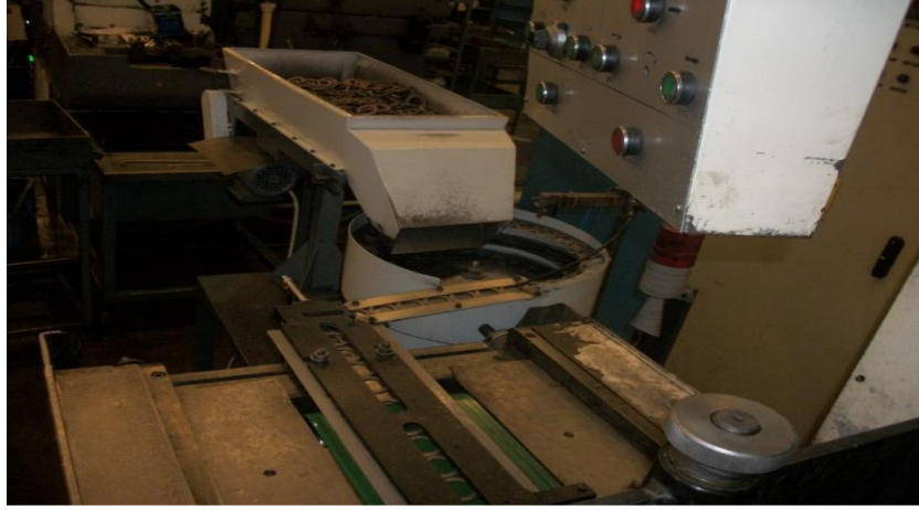
řekil 4.14: Sarsak ve itici & kanallı aparat (Akdamar 2014).
