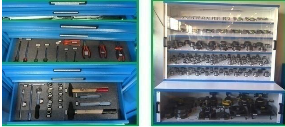
Şekil 4.24: 5S çalışmasından sonra takım ve masterların görünümü (Akdamar 2014).
