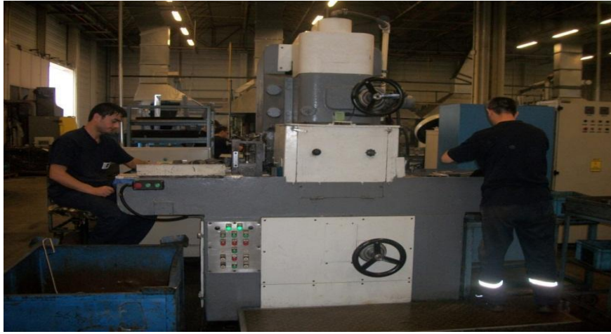
Şekil 4.13: İki operatörle çalışan kalınlık taşlama süreci (Akdamar 2014).
