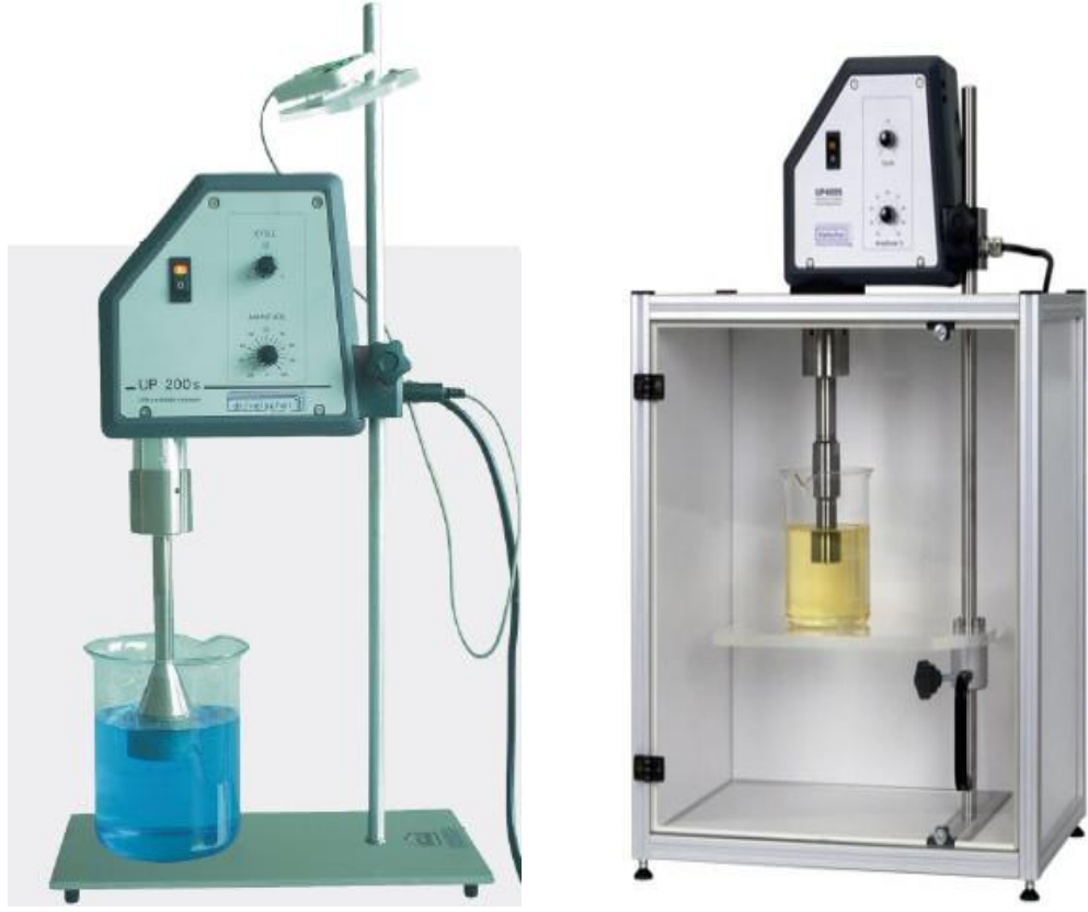
Şekil 1.13: Probu ultrasonik cihaz ve ses kabini (Anonim 2014).
