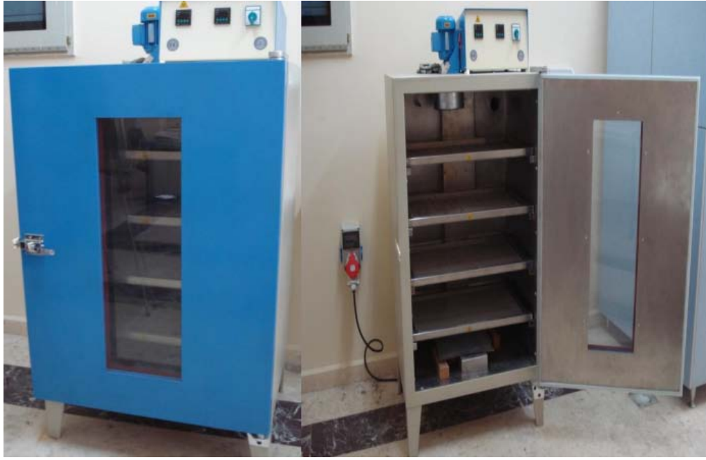
Şekil 3.7: Kabin kurutucu genel görünüm (Demiray 2009)
