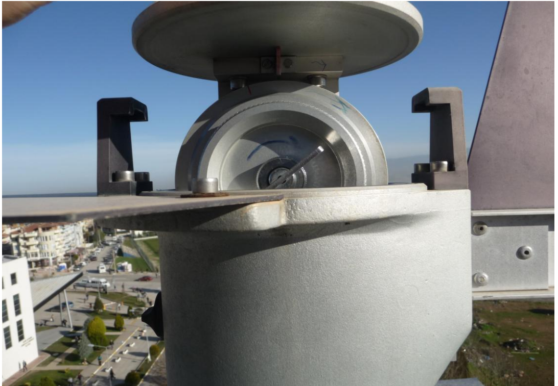
Şekil 2. Cihazın ana gövdesi içerisine yerleştirilen döner çark.
