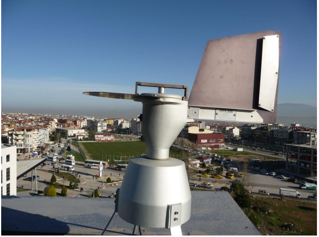
Şekil 1. Lanzoni VPPS 2000 polen toplama cihazının görünüşü
