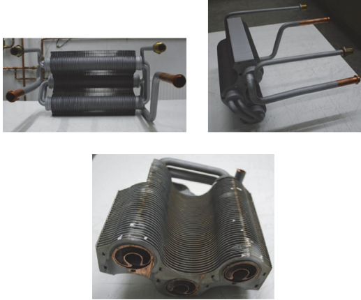
Şekil 2. K1 kombinin bileşik ısı eşanjörünün farklı açılardan görünümü (Different views of the combined heat exchanger of the K1 combi boiler)
