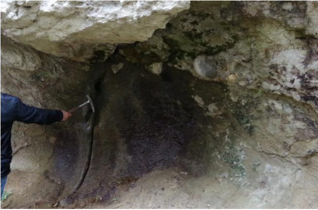
Şekil 13: Yeraltı su yapısından (kayadan) zemine sızan su.
