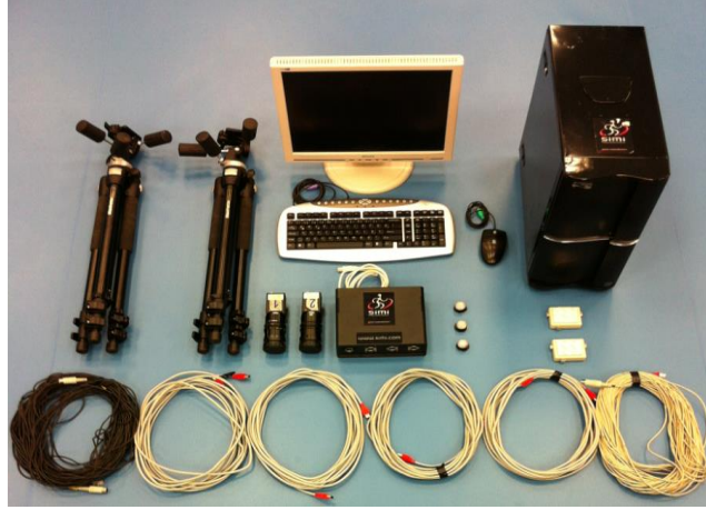
Resim 3.2 Deney düzeneğinde kullanılan hareket analizi sistemi (SIMI 7.5).
