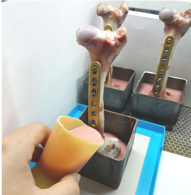
Şekil 3.22: Kemiklerin metal kalıplara yerleştirilmesi işlemi.
