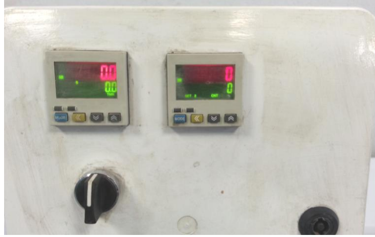
Şekil 3.3: Vuruş sayısını ve deney süresini hesaplayan sistem.
