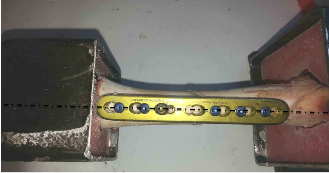
Şekil 4.23: Kombinasyon 3 Numune 3 deney öncesi görünümü.
