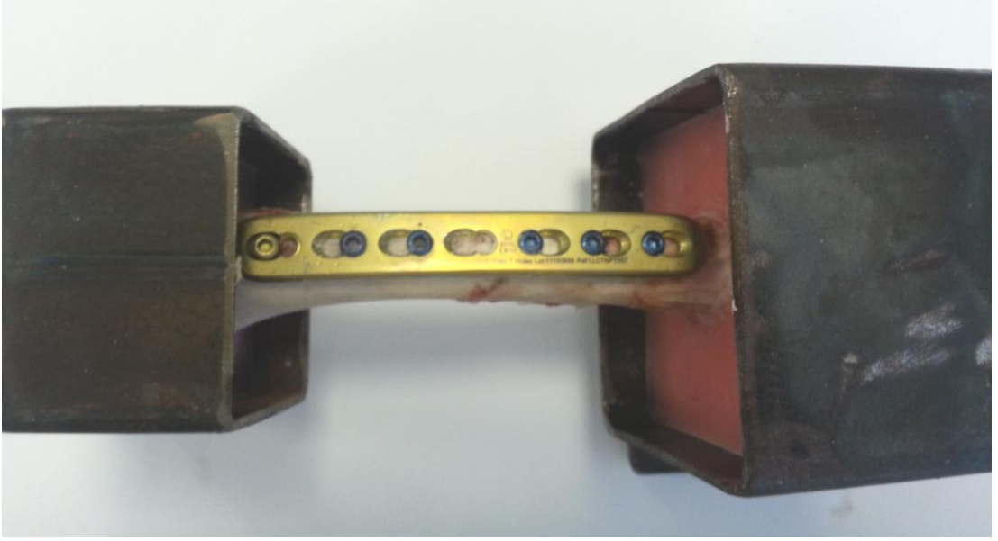
Şekil 3.23: Kalıplama işlemi biten deney numunesi.
