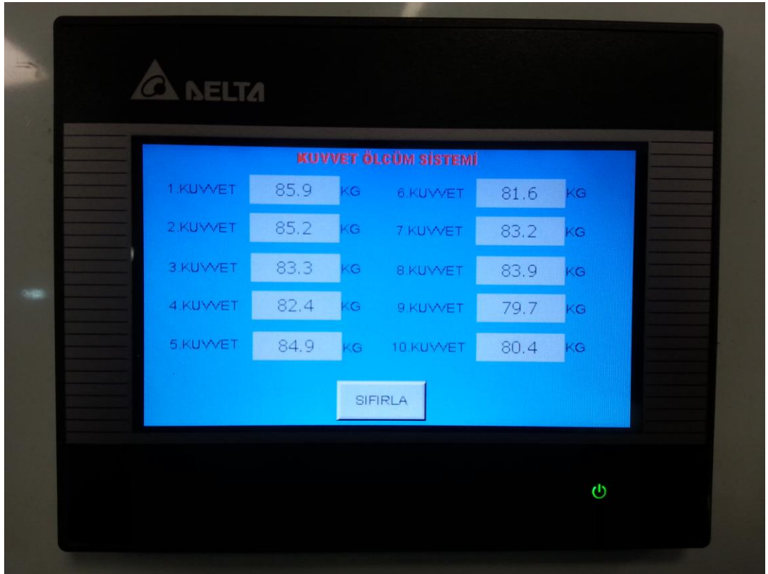
Şekil 3.2: Kuvvet ölçüm sistemi ekranı.
