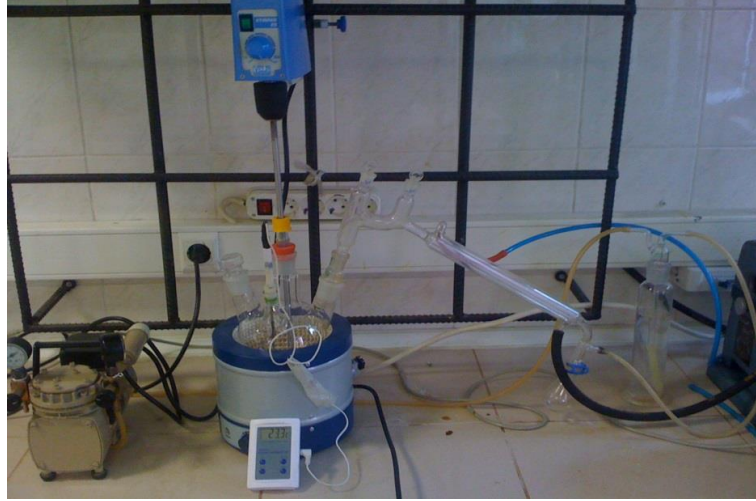
Resim 3.1: Bütül-glikozid ve alkilpoli glikozidlerin sentezlerinde kullanılan deney düzeneği
