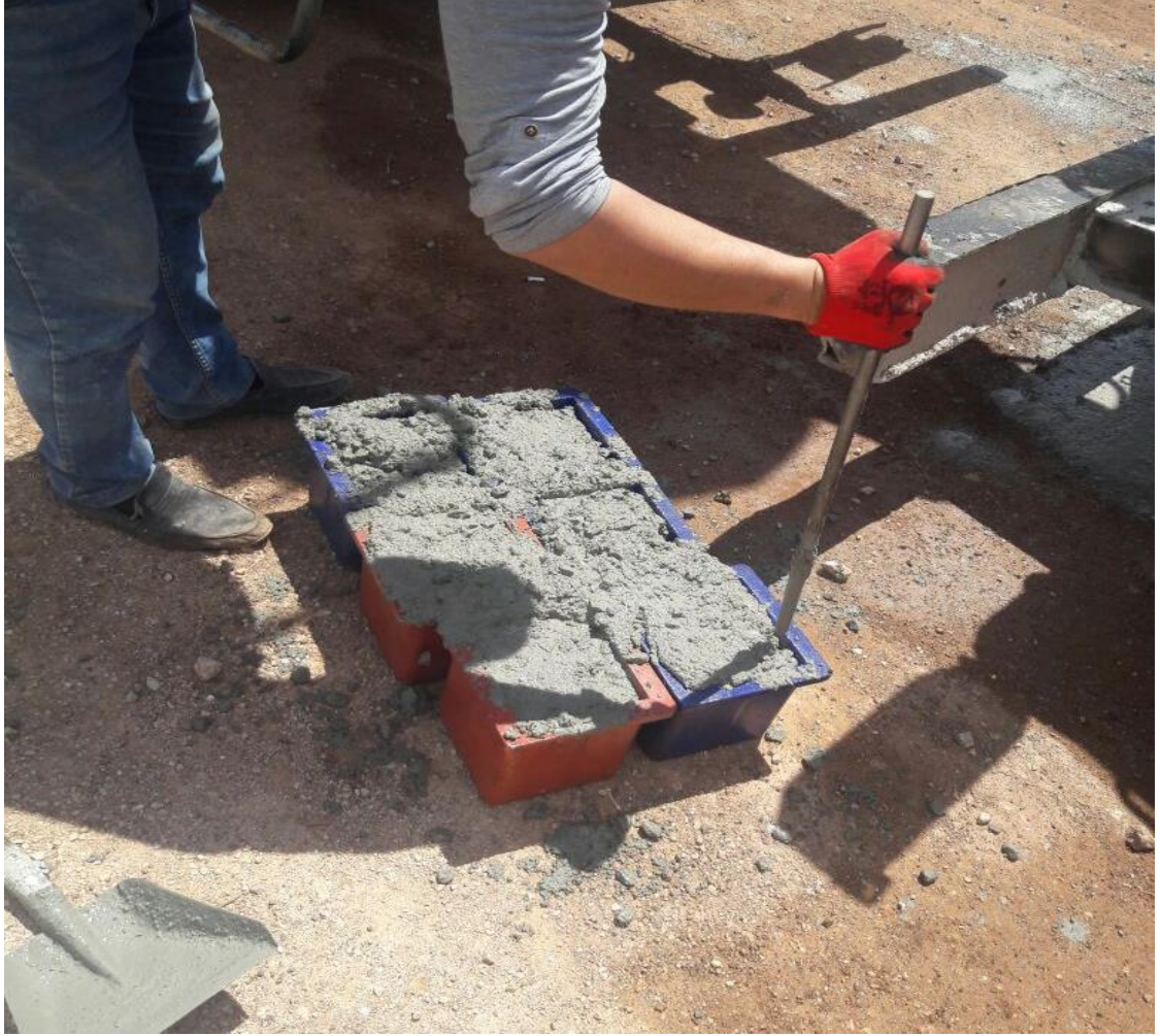
Şekil 2.11: Hazır Beton Numune Alınması
