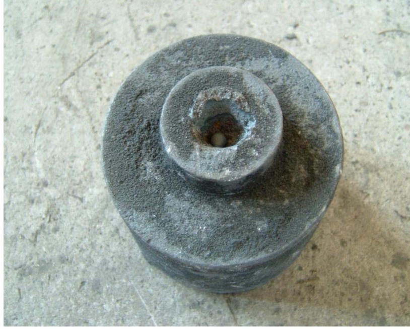
Şekil 4.6: Saçma hatalı döküm iş parçası (Harran Üniversitesi 2016).
