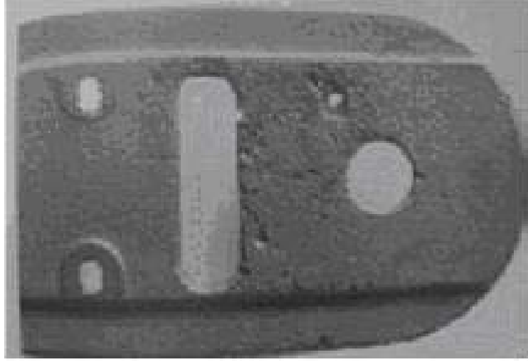
Şekil 4.5: Kum düşmesi sonucunda döküm yüzeyinde oluşan boşluk ve fazlalıklar (Harran Üniversitesi 2016).
