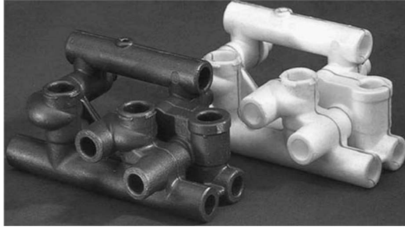
Şekil 2.15: Dolu kalıba döküm. Döküm manifold ile kayıp köpük döküm için model (ASM International 2009).
