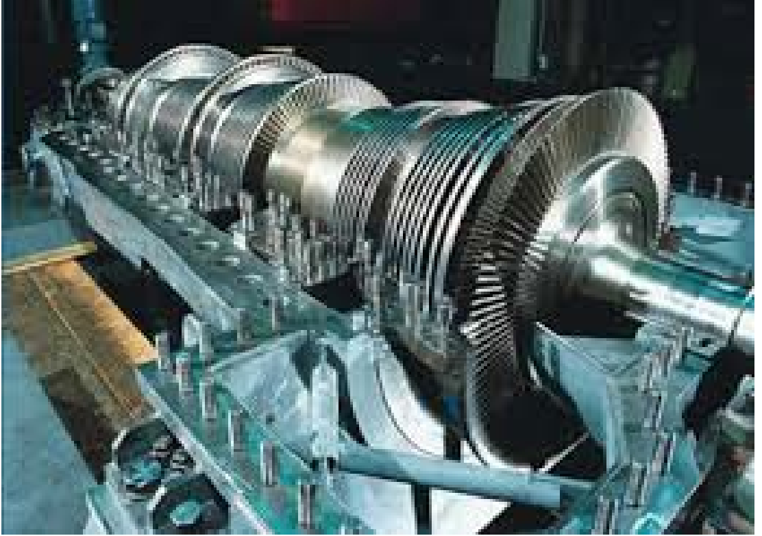
Şekil 4.7: Reaksiyon türbini karter açılmış durumda (Alibaba 2016)
