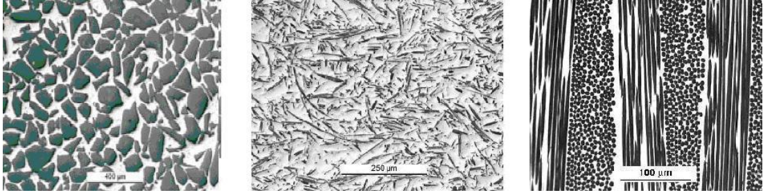
Şekil 1.1: Takviye malzemesinin geometrisine göre metal matrisli kompozitler, a) Parçacık Takviyeli b) Kısa Fiber Takviyeli c) Sürekli Fiber Takviyeli Metal Matrisli Kompozit Malzemelerde Matris Malzemeleri
