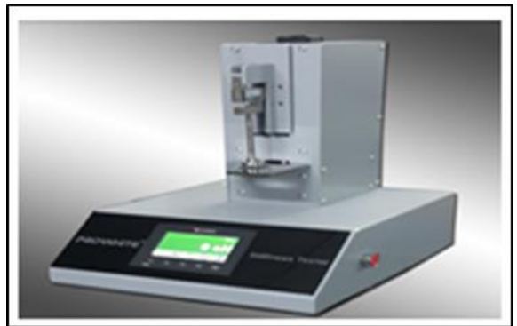
(b): Prowhite dijital pnömatik kumaş sertliği ölçüm cihazı.
