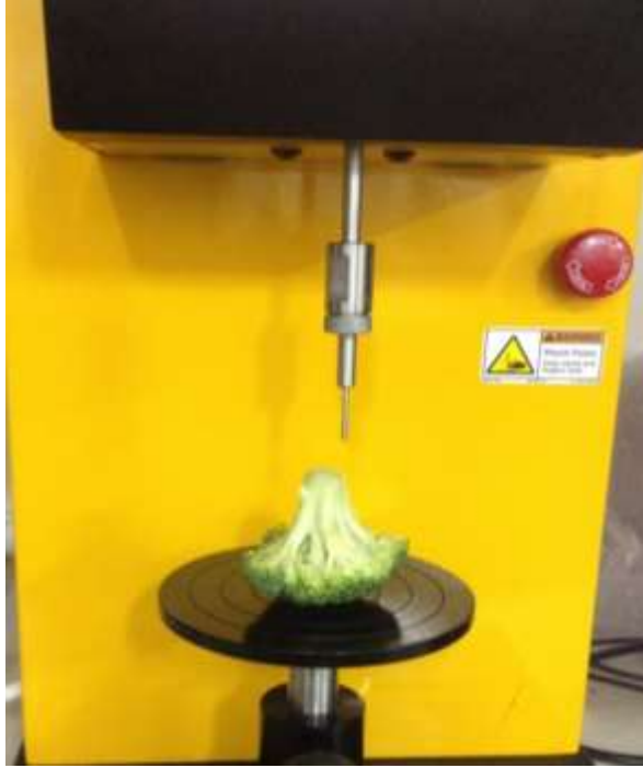
Şekil 3.10: Tekstür analizi sırasında brokolinin görünümü
