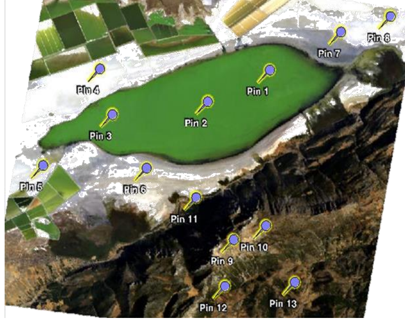
Şekil 11. 5: Atmosferik düzeltme sonrası farklı litolojilerin spektral eğrilerinde meydana gelen değişimlerin incelendiği test (Pin) noktaları.
