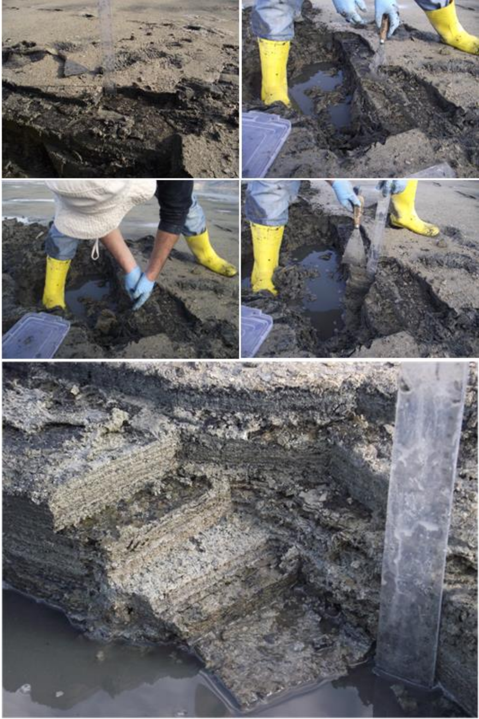
Şekil I. 3: Acıgöl'de göl yüzeyinde siğ trenç uygulaması ile siğ kolon örnekleme ve gölde mikro ölçekte görelen istiflenme.
