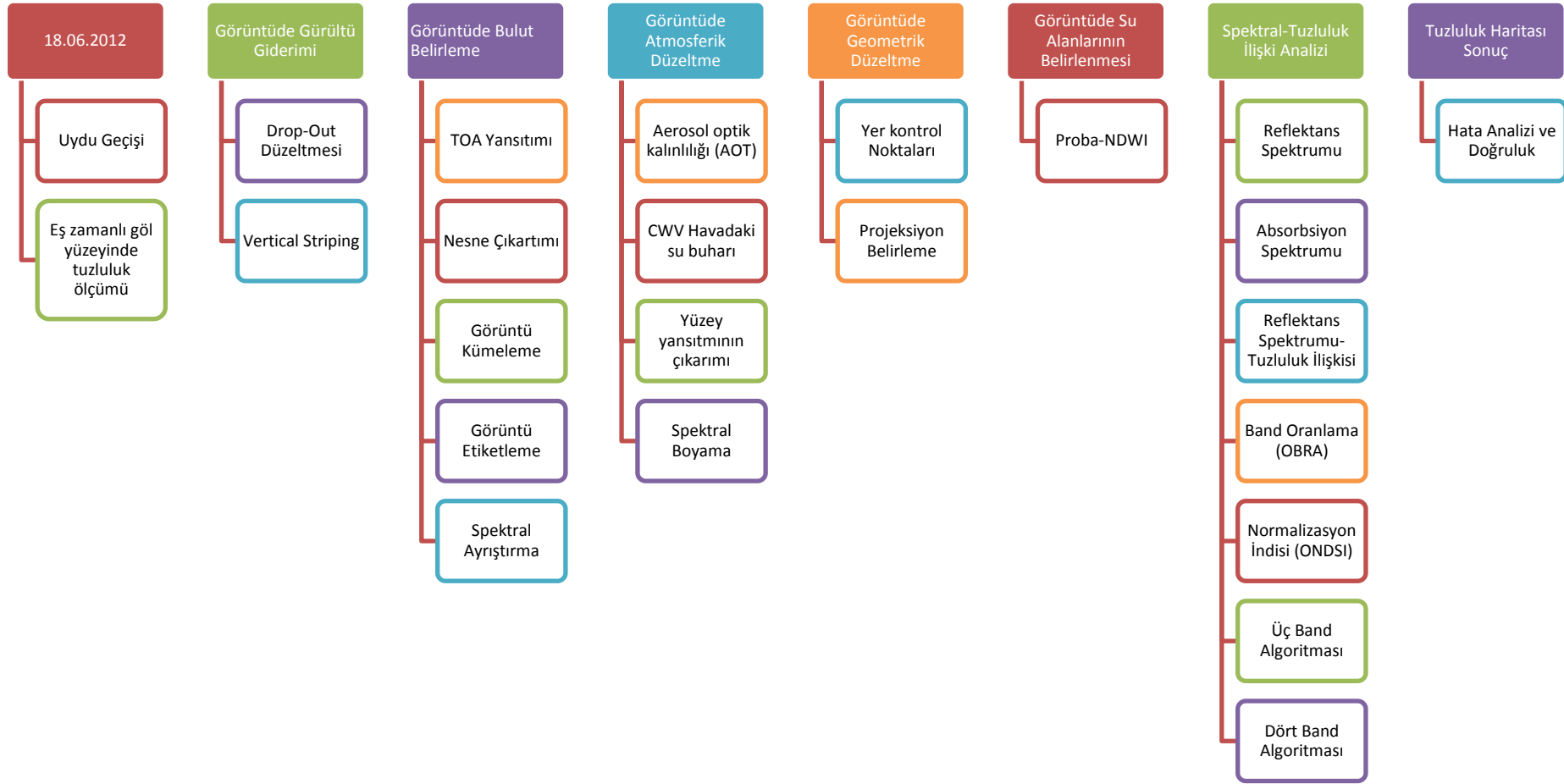
Şekil 12. 5: CHRIS/Proba Uydu görüntüsünden göl tuzluluğunun belirlenmesinde yöntem.
