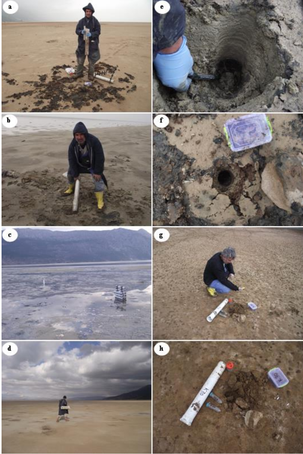
Şekil I. 4: Göl yüzeyinde karot örneklemeleri a) Gölün doğusunda sığ karot örneği alımı b)gölün güneyinde sığ karot örneği c,d)karot almak için kullanılm malzemeler e,f)karot alınan noktanın karot sonrası görünümü g)karot noktasının GPS ile konumlandırılması h) karot noktasında aynı anda, yüzey sığ kolon örneklemeleri.
