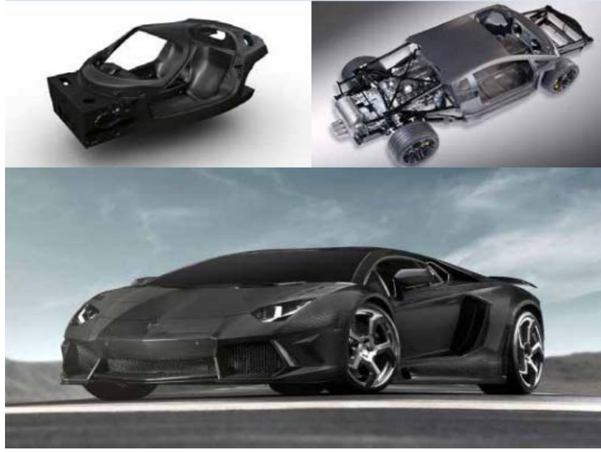
Şekil 9. 8 Bazı Lüks Araç Markalarında Karbon Elyaf İle Üretilen Parçalara Örnek [13]
