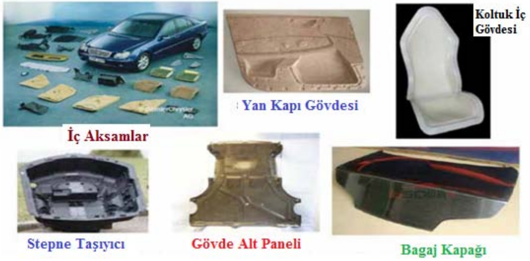
Şekil 9. 3 Orta Sınıf Bir Araçta Doğal, Cam, Karbon Elyaftan Yapılmış Parçalara Örnekler [13]
