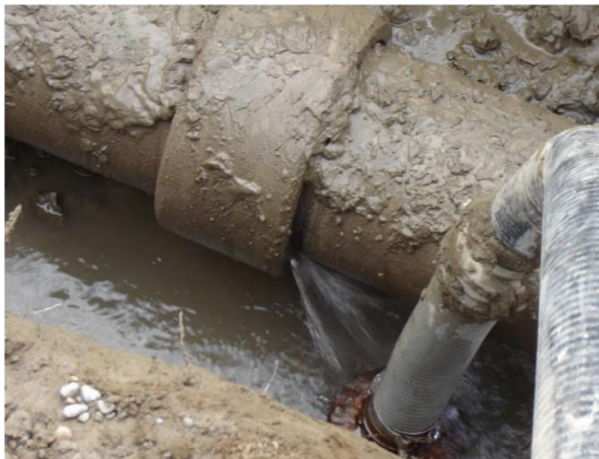
a) AC boru bağlantısındaki gerginlik etkileri, Sewfield Street Kaiapoi, Darfield merkez üssüne göre aksnel, 2010, (O'Callaghan, 2014)
