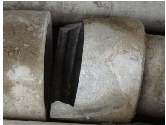
b) AC boru bağlantısındaki sıkıştırma etkileri, Sewell Street, Kaiapoi, Darfield merkez üssüne eksensel olarak hizalı, 2010, (O'Callaghan, 2014)
