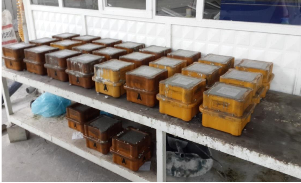
Şekil 3.14: Beton basınç dayanımı tayininde hazırlanan numune kalıplarına örnek.
