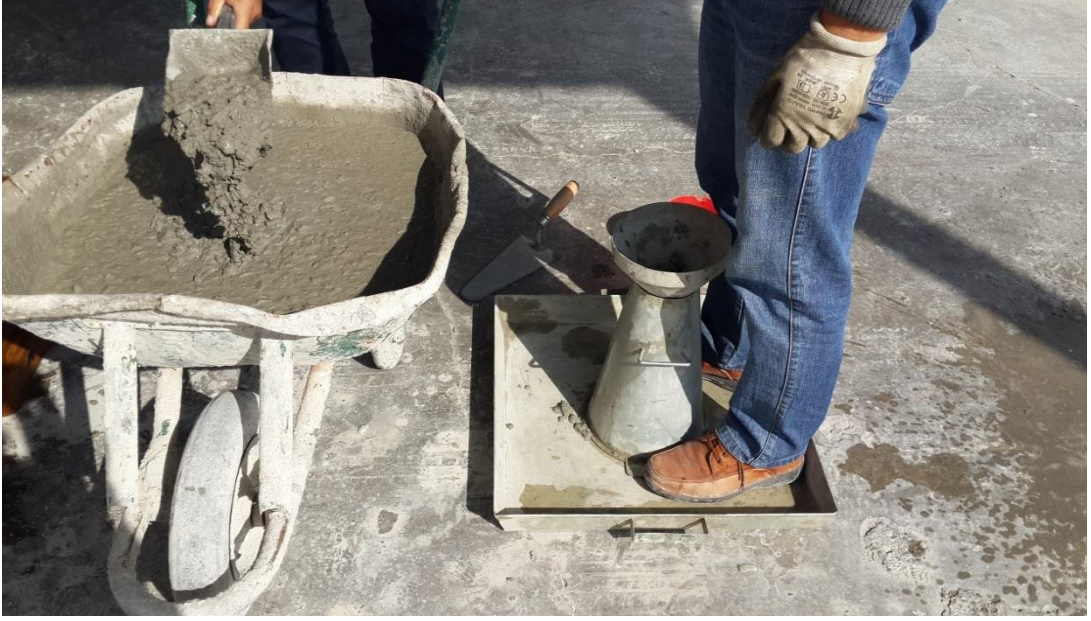
Şekil 3.8: Kıvam deneyi, huninin yerleştirilmesi ve taze beton numunesinin huniye doldurulması.
