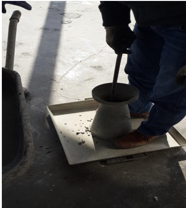
Şekil 3.9: Kıvam deneyi, taze betonun şişlenerek sıkıştırılması işlemi.
