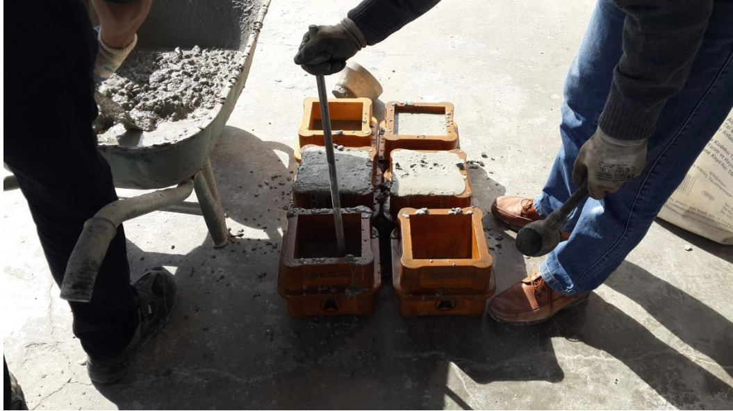
Şekil 3.12: Priz süresi tayininde taze beton numunesinin şişlenerek içerisindeki hava kabarcıklarının giderilmesi işlemi.
