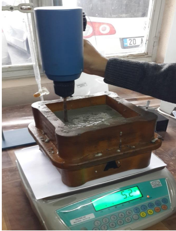
Şekil 3.13: Priz süresi tayininde kullanılan yük uygulama cihazı ve kuvvet uygulama işlemi.
