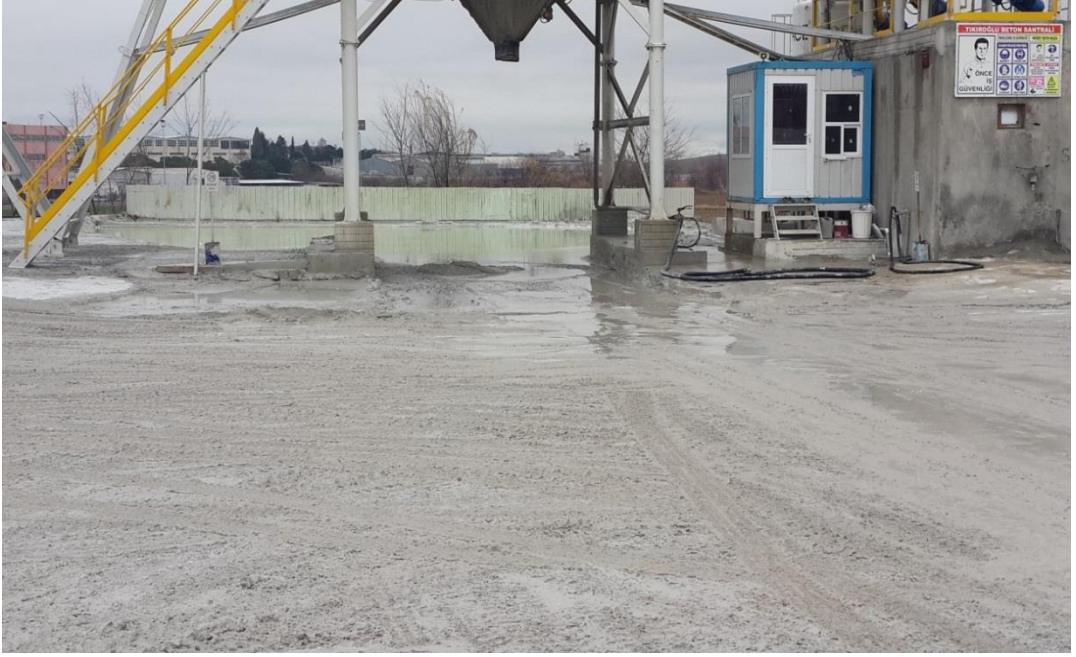
Şekil 3.5: Hazır beton tesis sahasından yağmur suyu akışından oluşan atıksu.
