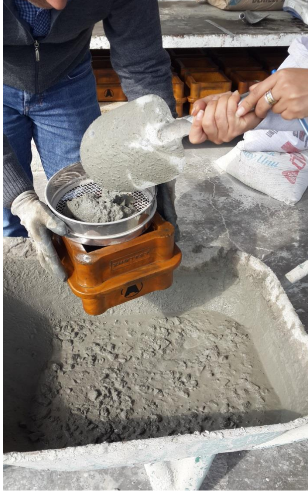
Şekil 3.11: Priz süresi tayininde taze beton numunesinin elenerek numune kalıbına koyulması işlemi.
