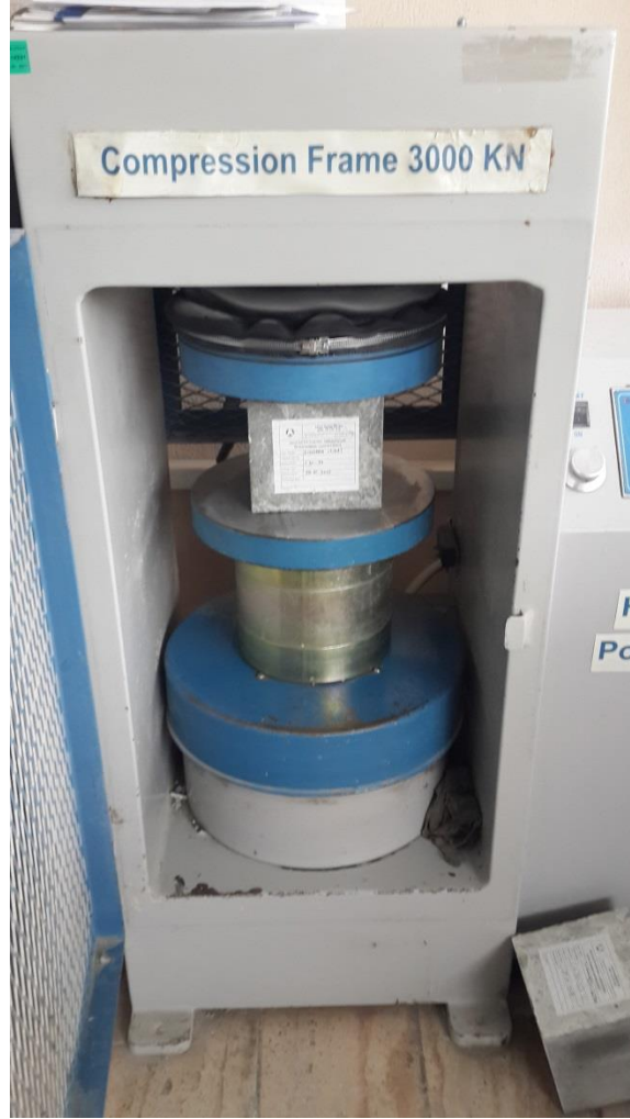
Şekil 3.16: Beton basınç dayanımı tayininde kullanılan kırma makinası.
