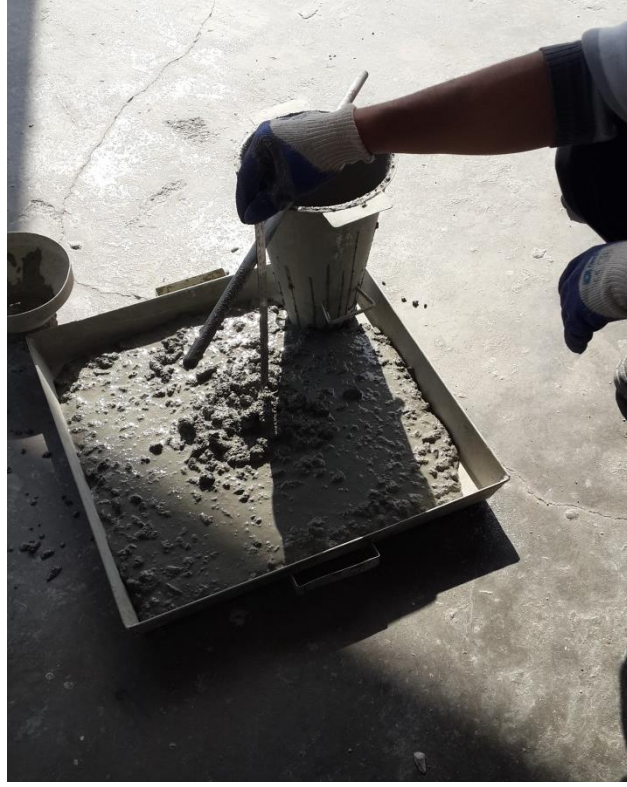
Şekil 3.10: Kıvam deneyi, taze betonun çökme miktarının belirlenmesi.
