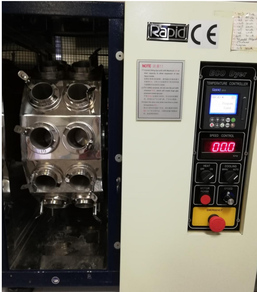
Şekil 3. 4. Rapid: EcoDyer laboratuvar tipi boyama makinesi
