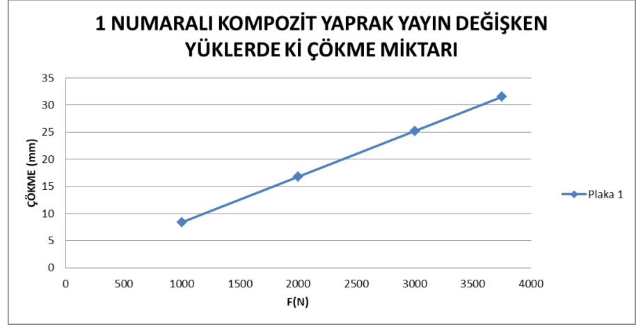
Şekil 4.10 Değişken yüklerde katkısız kompozit yaprak yayın çökme grafiği
