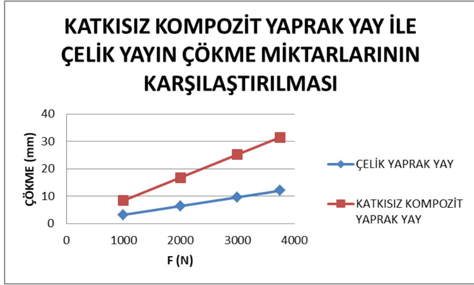
Őekil 4.12 DeđiŐken y¼kler altında elik ve katkısız kompozit yaprak yayda oluŐan ¼kme miktarlarının karŐılaŐtırılması
