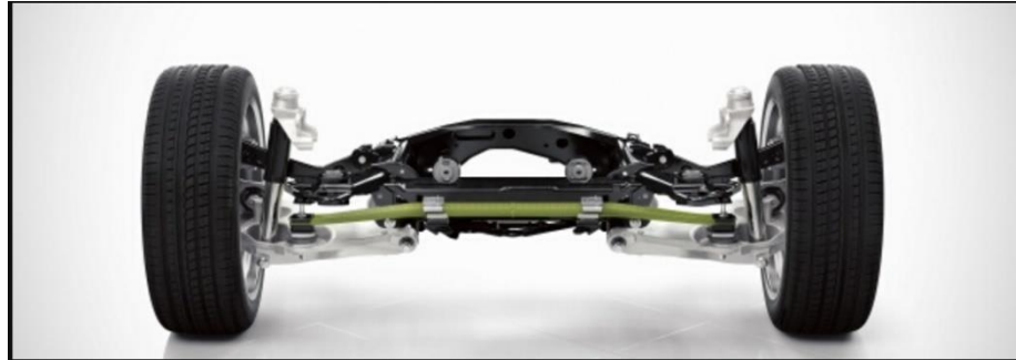
Şekil 1.2 Cam elyaf karbon elyaf epoksi kompozit yaprak yay (Henkel firması 2017)
