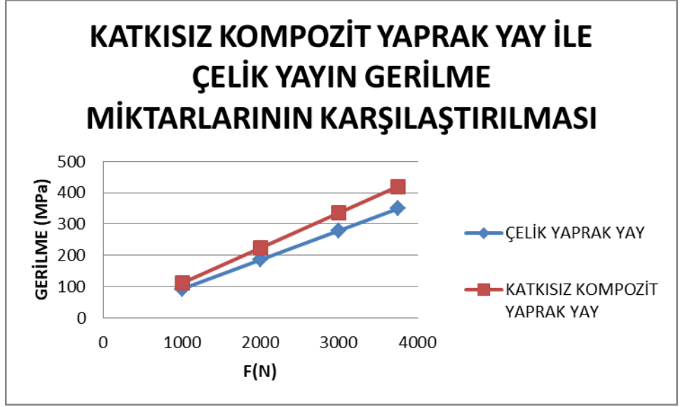
Şekil 4.13 Değişken yükler altında çelik ve katkısız kompozit yaprak yayda oluşan gerilme miktarlarının karşılaştırılması
