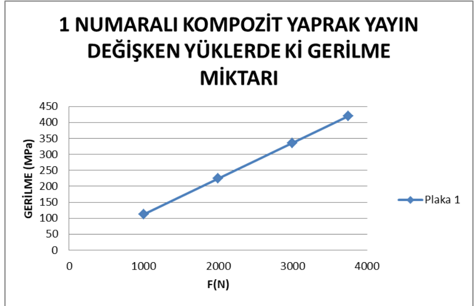
Şekil 4.11 Değişken yüklerde katkısız kompozit yaprak yayda oluşan gerilme grafiği
