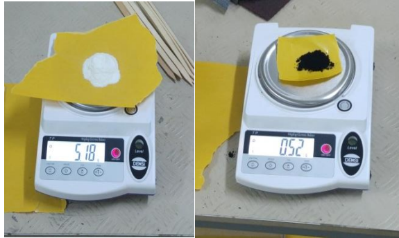
Şekil 2.1 Kitosan (K) ve karbon nanotüp'ün (KNT) hasas terazi ile tartımı
