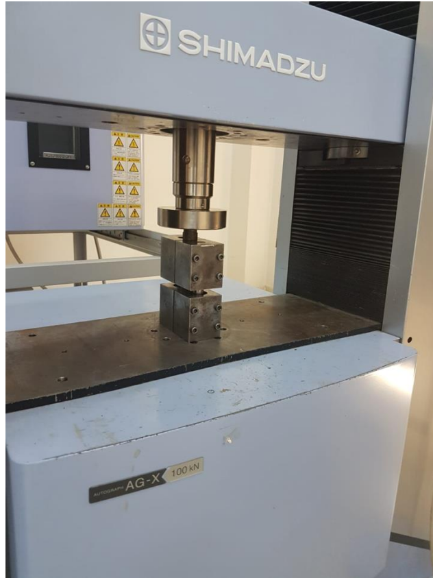
Şekil 3.4 Deney numunesine basma testinin uygulanması
