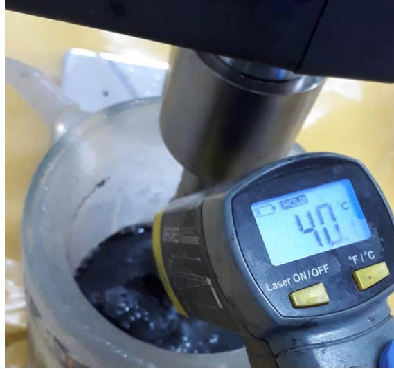
Şekil 2.3 Karıştırma işlemi esnasında sıcaklığın kontrol altında tutulması
