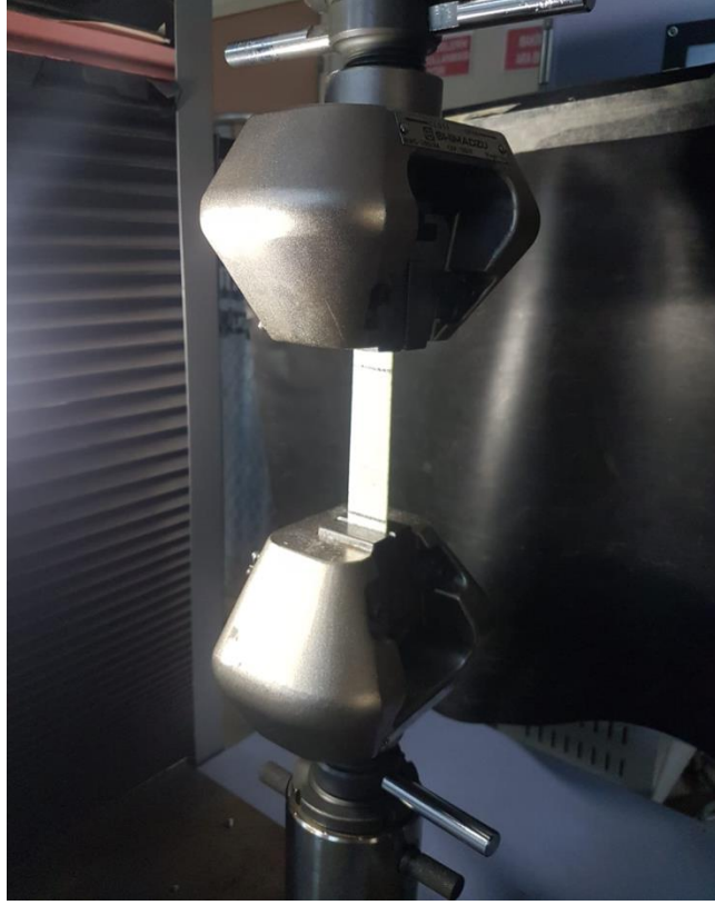
Şekil 3.2 Deney numunesine çekme testinin uygulanması
