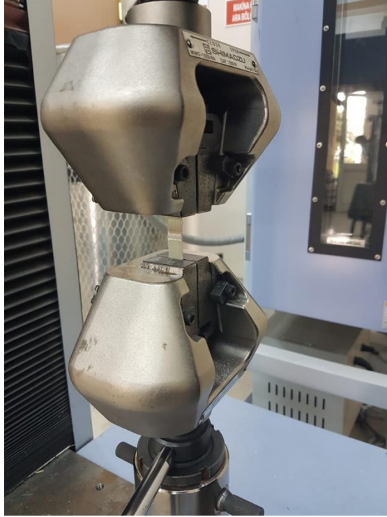
Şekil 3.7 Çentikli numuneye çekme testinin uygulanması
