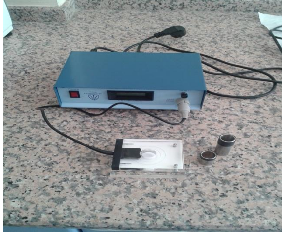
Şekil 7. 6: KES Testi düzeneği
