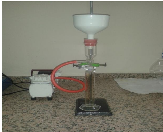
Şekil 7. 7 : Buchner Hunisi Testi düzeneği
