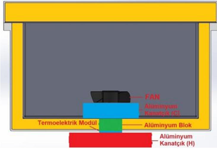
Şekil 5.17: Hava soğutmalı termoelektrik dolap şematik gösterim (kanatçık altta)
