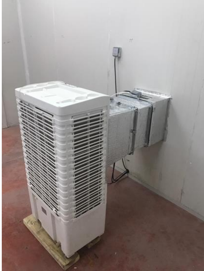
Şekil 5.2: Buharlaşmalı Soğutucunun ölçüm istasyonuna bağlanması (arka görünüş)
