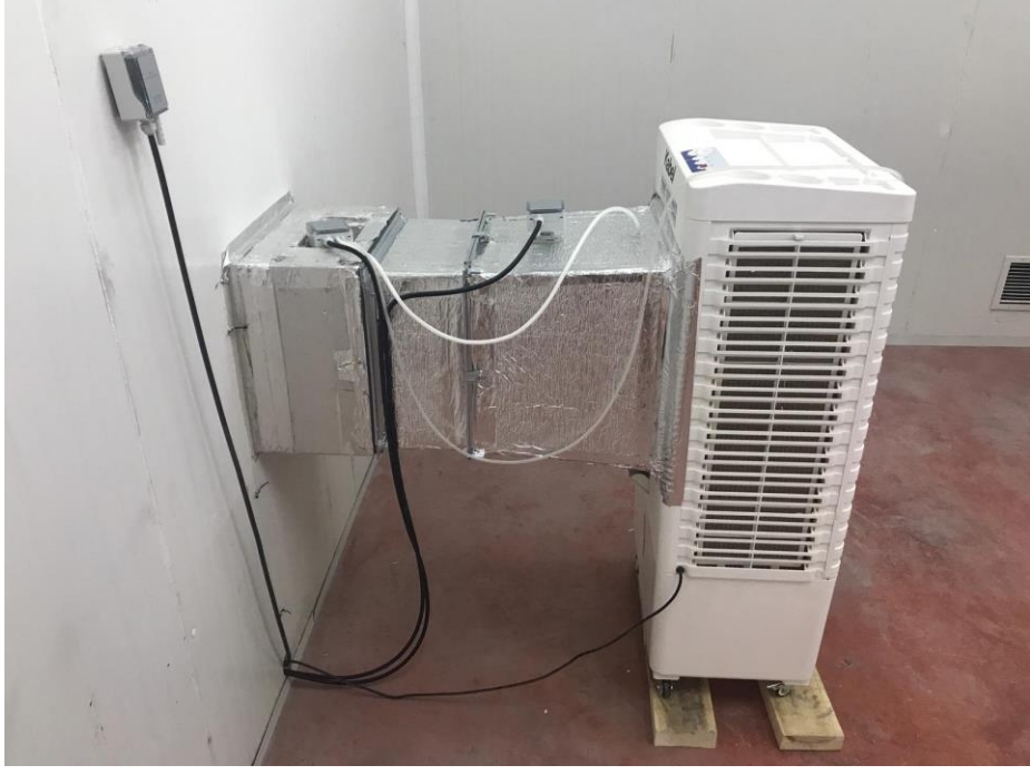
Şekil 5.1: Buharlaşmalı soğutucunun ölçüm istasyonuna bağlanması
