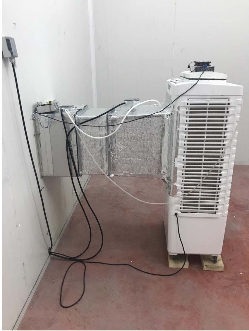
Şekil 5.20: Hava soğutmalı (çevre ortamındayken) termoelektrik dolap ile buharlaşmalı soğutucunun ölçüm istasyonuna bağlanması
