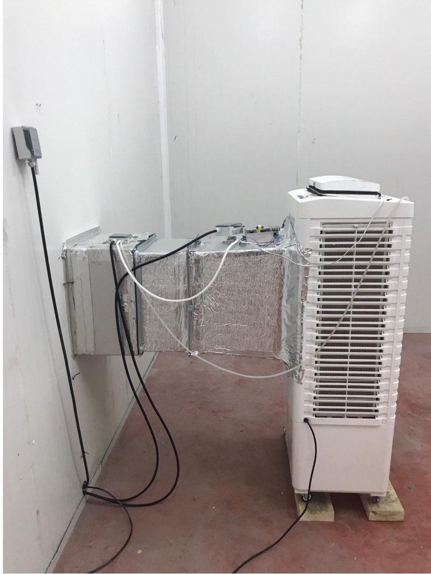
Şekil 5.25: Su soğutmalı termoelektrik dolaplı buharlaşmalı soğutucu ölçüm istasyonuna bağlanması
